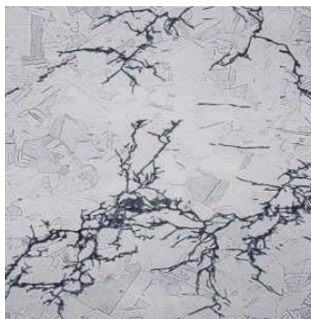
Slika 24. Transkristalna napetosna korozija AISI 316 čelika[25]
