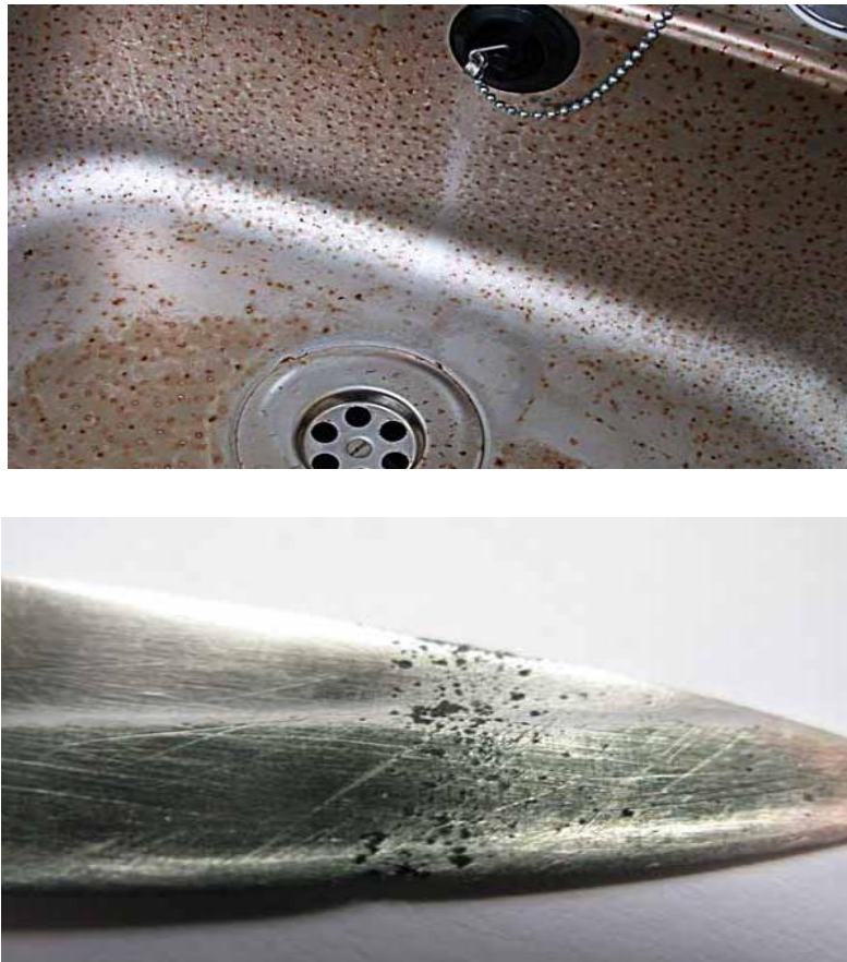
Slika 13. Primjeri djelovanja rupičaste korozije na razne vrste čelika [17]
