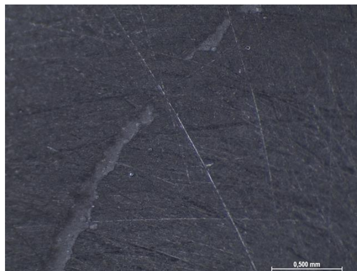
Slika 61. Detaljnije stereomikroskopske snimke površine uzorka od čelika AISI 316L nakon cikličke polarizacije u vodi s 19000 ppm Cl -
