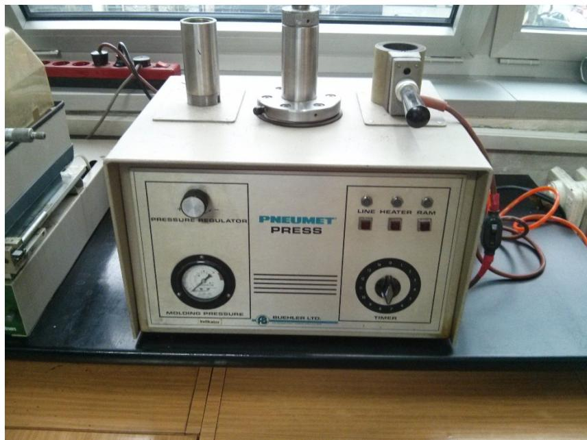
**Slika 25. Uredaj za ulijevanje Buehler Pneumett Press**
