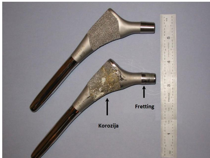
Slika 5. Korozija na femuralnom dijelu implantata kuka [8]
