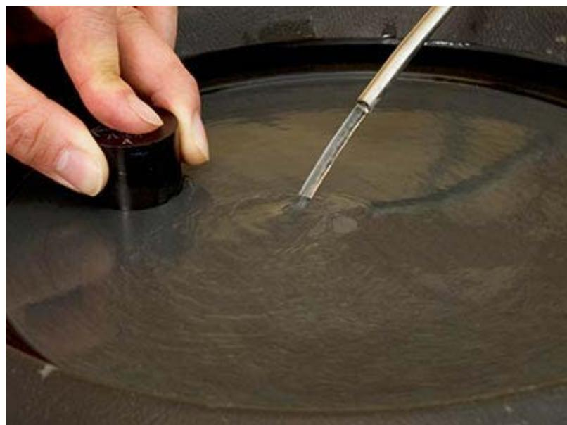
Slika 20. Brušenje uzoraka ručnom silom uz hlađenje vodom [46]
