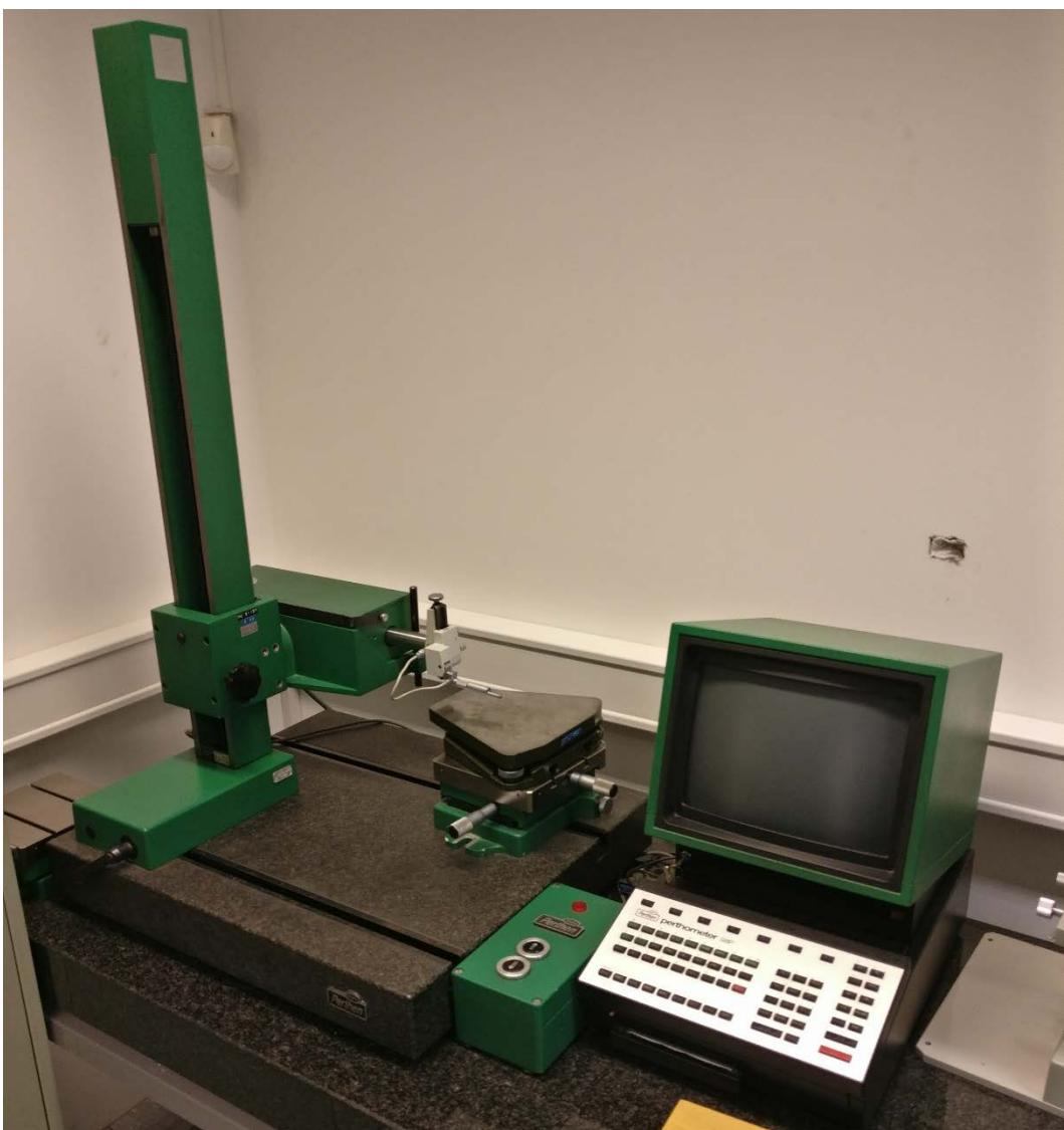
Slika 27. Mahr Perthen Perthometer S8P instrument s ticalom
