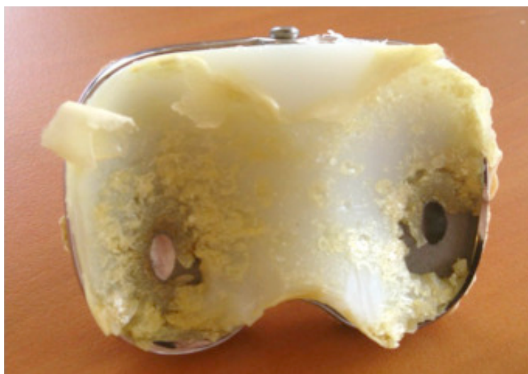
Slika 7. Potrošeni polietilenski dio implantata koljena [11]
