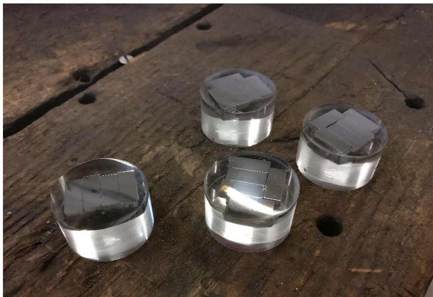
Slika 26. Kapsulirani uzorci nakon mehaničke pripreme površine
