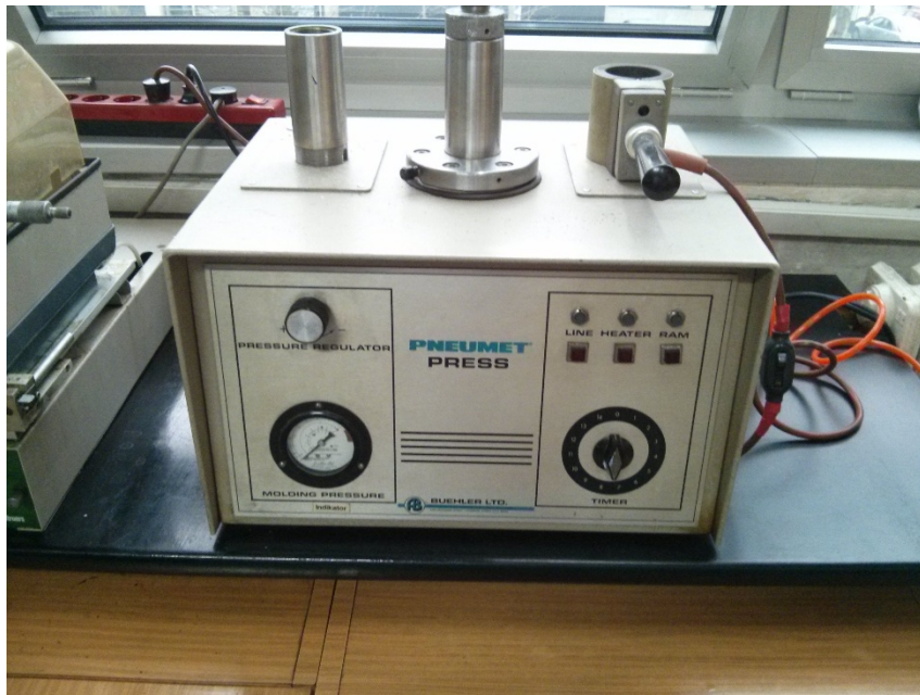
Slika 25. Uređaj za ulijevanje Buehler Pneumett Press
