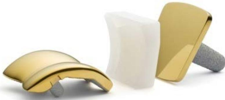
Slika 22. Dijelovi implantata koljena prevučeni TiN-om [52]
