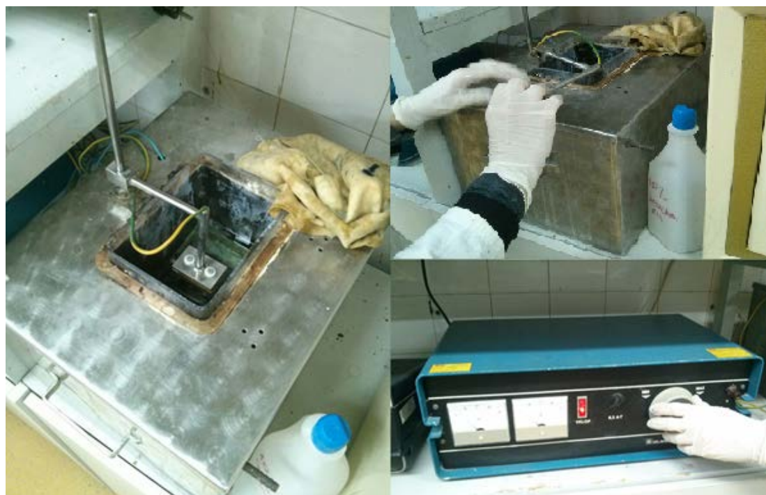
Slika 38. Oprema za elektropoliranje
