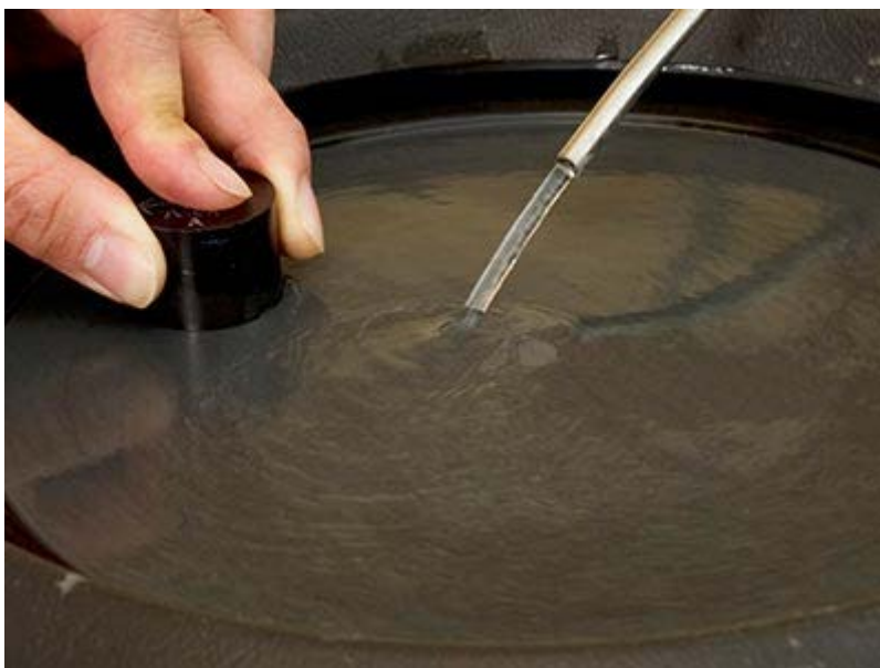
Slika 20. Brušenje uzoraka ručnom silom uz hlađenje vodom [46]
