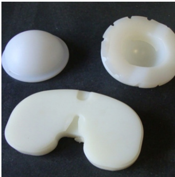
Slika 11. Dijelovi ortopedskih implantata od UHMWPE [24]
