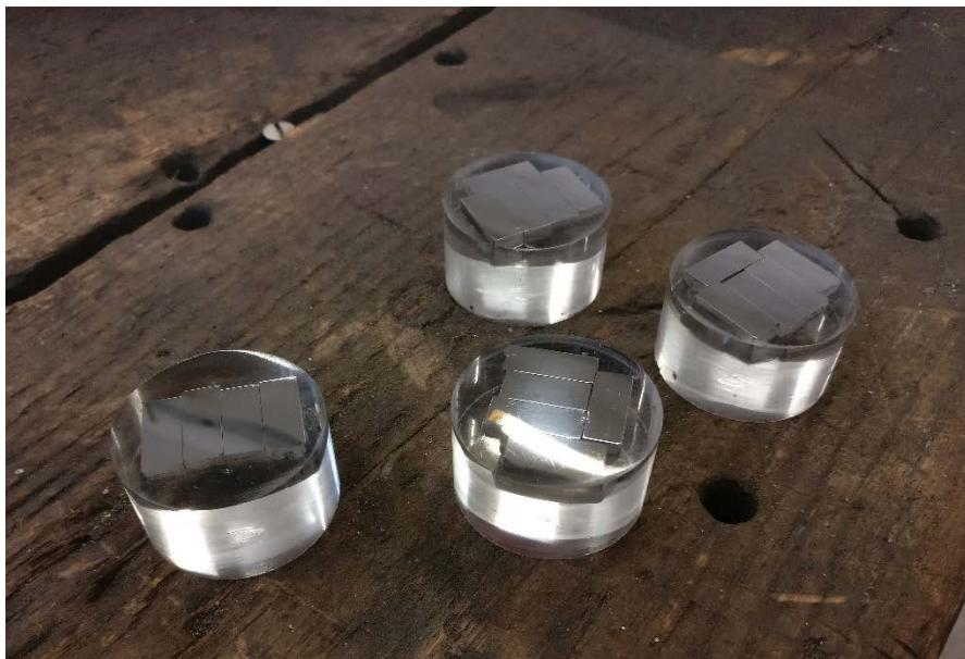
Slika 26. Kapsulirani uzorci nakon mehaničke pripreme površine
