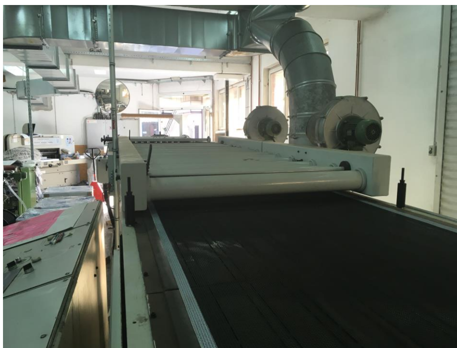
Slika 24. Dio stroja s fenovima za vrući zrak
