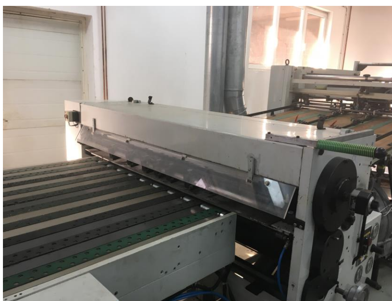
Slika 21. Dio stroja za uklanjanje pudera papira
