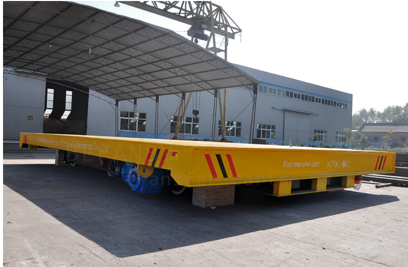
Slika 1.4: Kolica sa vlastitim izvorom energije (baterija) prema [1]
