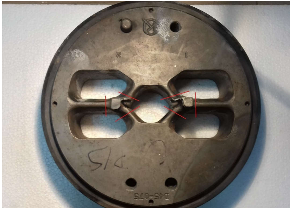
Slika 19. Mjesta izrezivanja uzorka
