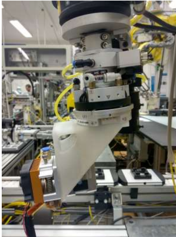
Slika 7. Ekstruder montiran na robotsku ruku
