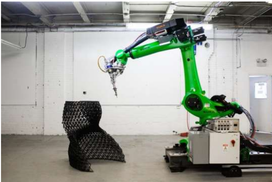
Slika 3. Robotsko 3D tiskanje [8]
