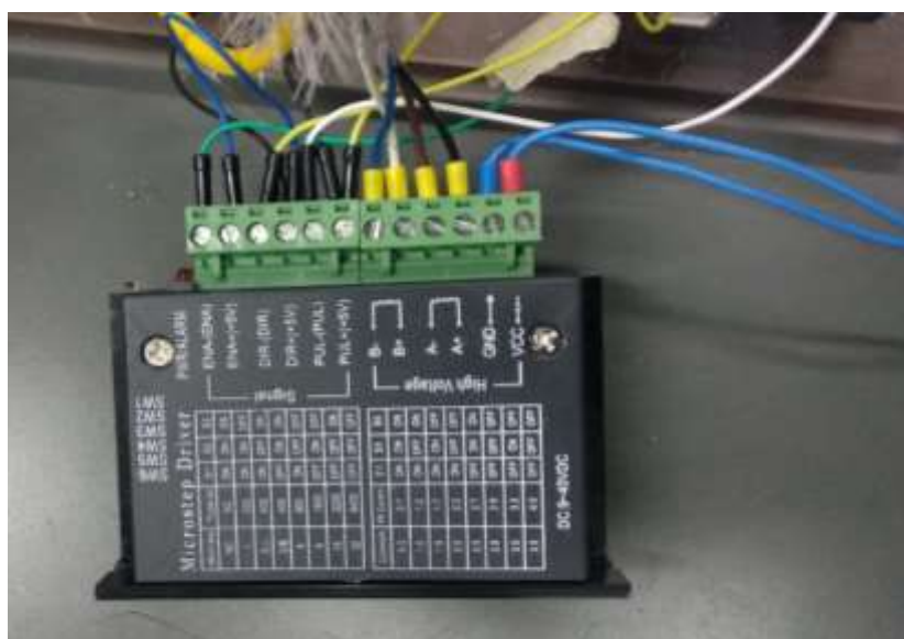
Slika 14. TB6600 kontroler za koračne motore
