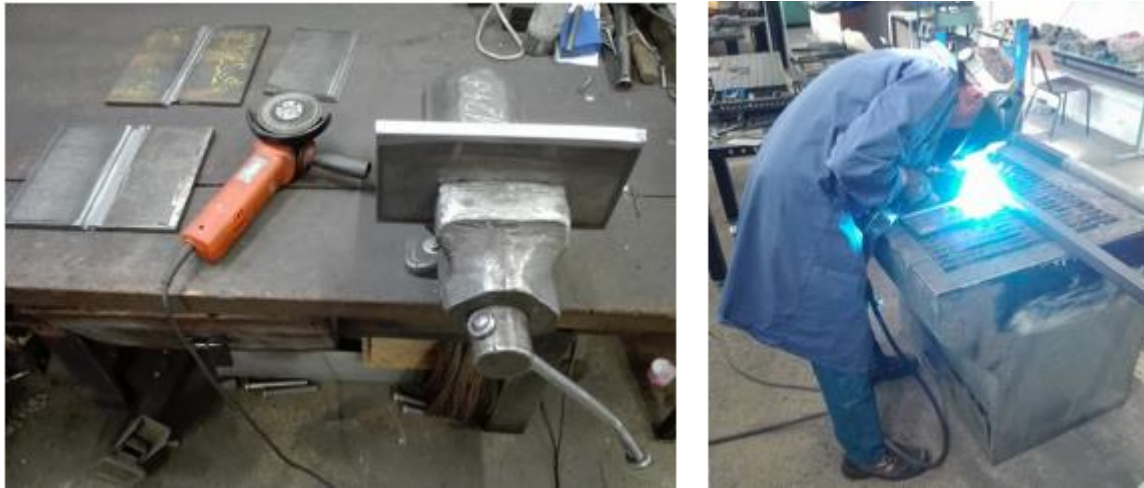
Slika 56. Postupak brušenja (lijevo) i pripajanja (desno) uzorka
