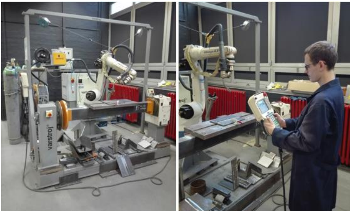
Slika 11. On - line metoda programiranja robota
