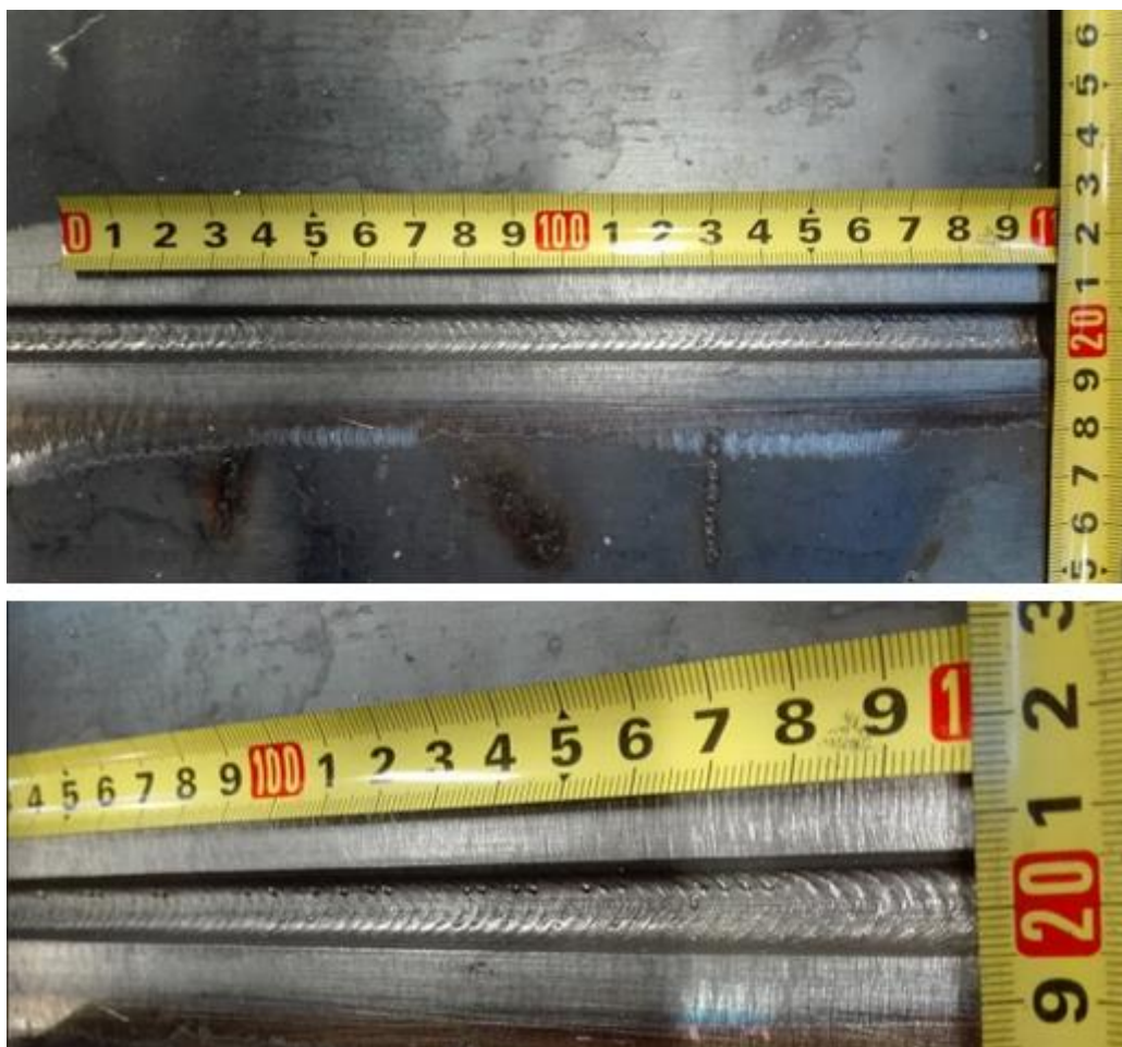
Slika 62. Izgled zavarenog spoja korijena
