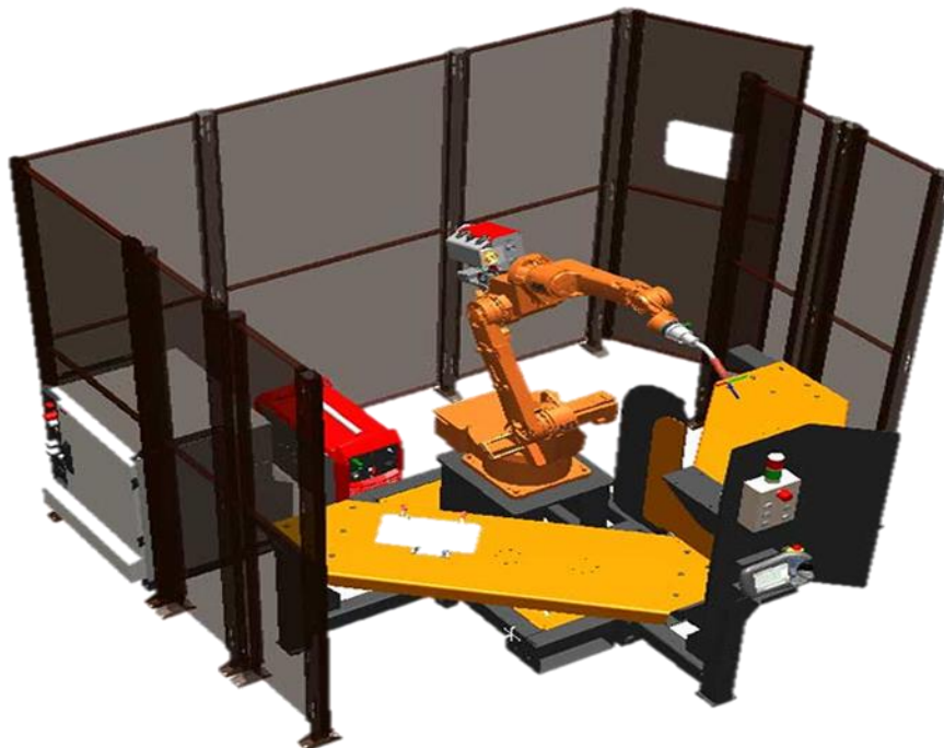
Slika 9. Robotizirana zavarivačka stanica s dvije palete i steznim napravama [19]
