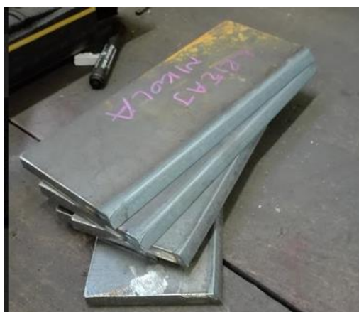
Slika 55. Uzorci - čelične ploče S235JR
