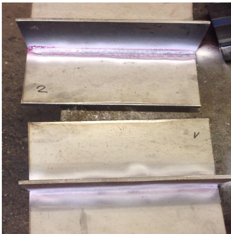
Slike 21. i 22. uzorci nakon što se razvijač osušio
