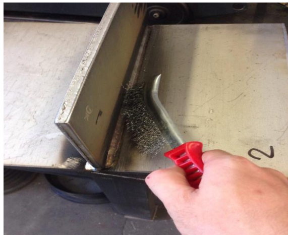
Slika 16. Čišćenje uzoraka četkom
