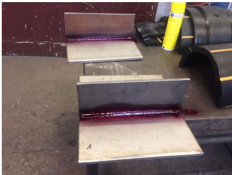
Slika 20. površine zavarenih spojeva s nanesenim penetrantom
