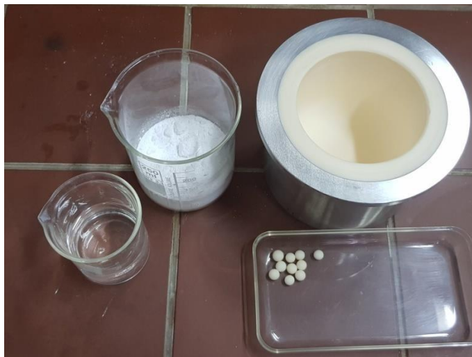
Slika 3.3 Otopina disperzanta, \text{Al}_2\text{O}_3 prah, \text{Al}_2\text{O}_3 kuglice te posuda za homogenizaciju (unutarnji dio posude je od \text{Al}_2\text{O}_3 keramike).
