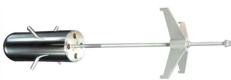
Slika 7. Izotermalni blok za termostatirane kupke
