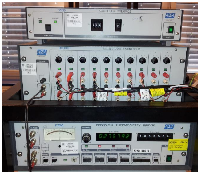
Slika 5. Termometrijski otpornički most (spojene sve navedene komponente)
