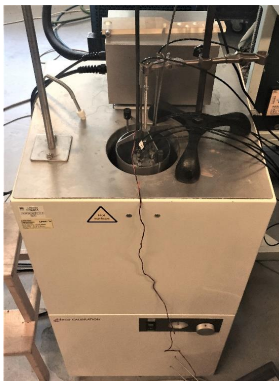
slika 9. Prikaz kupke, izotermalnog bloka i uronjenih termometara
