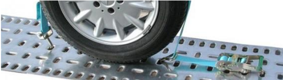
Slika 2. Način vezanja pomoću sigurnosnih traka [2]
