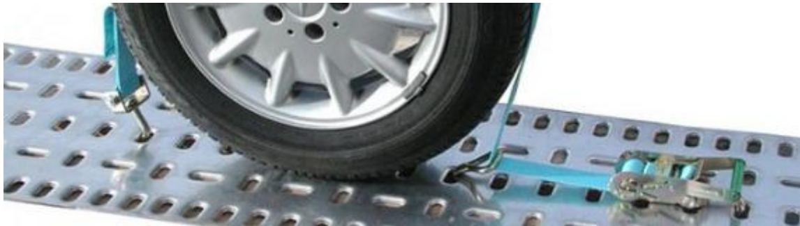
Slika 2. Način vezanja pomoću sigurnosnih traka [2]
