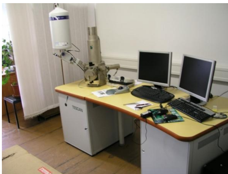
Slika 29. Skenirajući elektronski mikroskop
