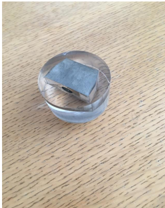
Slika 22. Uzorak zaliven u polimernoj masi
