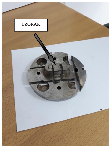
Slika 20. Alat izrezan na dijelove
