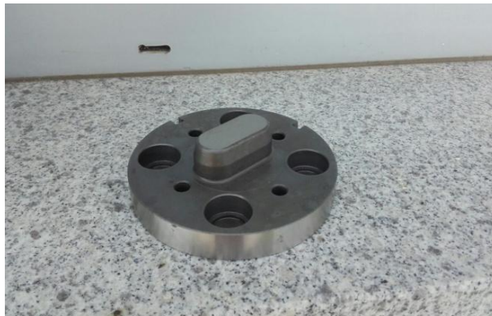
Slika 7. Alat za izvlačenje elipsi [2]
