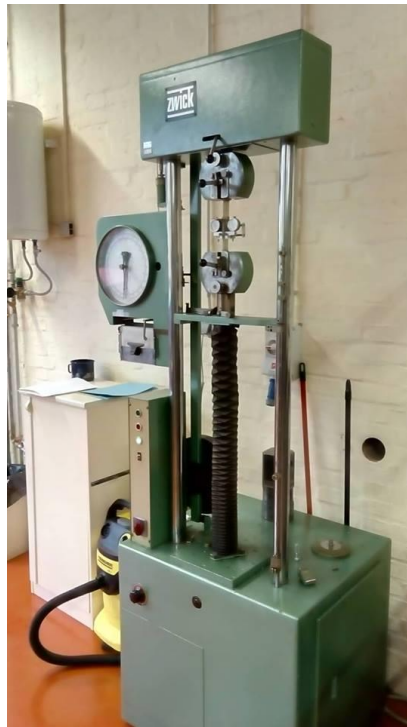
Slika 3.10. Kidalica proizvođača VEB Thüringer Industriewerk, Rauenstein, Njemačka; razredom točnosti 1,0 u mjernom području 0-4800 N
