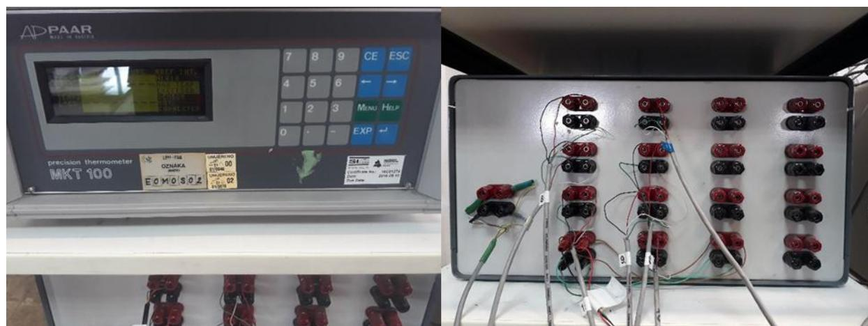
Slika 4. Etalonski termometrijski otpornički most
