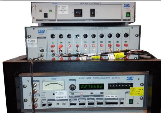
Slika 9. Etalonski termometrijski otpornički most
