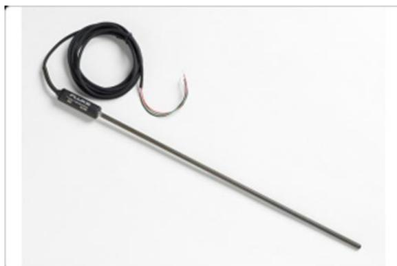
Slika 3. Etalonski termometar
