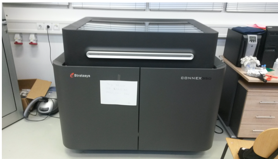
Slika 3.1: 3D printer korišten u ispisu epruveta
