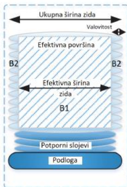
Slika 4. Zid izrađen WAAM postupkom [9]
