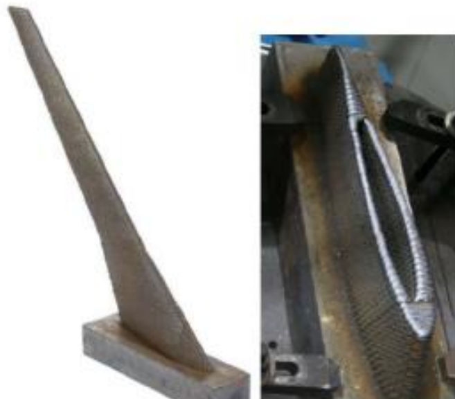
Slika 8. Model krila od visokočvrstog čelika izrađenog WAAM postupkom [17]
