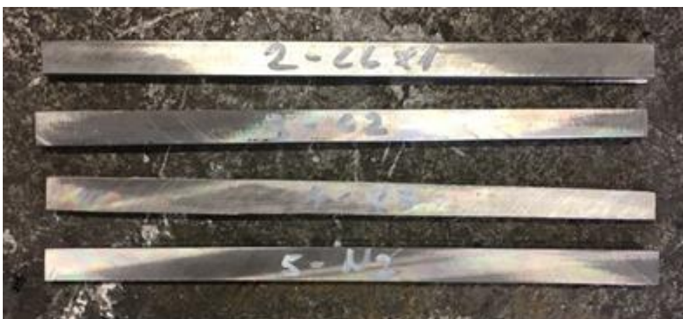
Slika 30. Epruvete izrezane iz zida izrađenog WAAM postupkom
