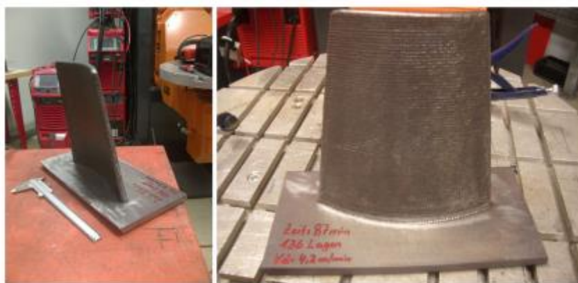
Slika 5. Komponenta izrađena od duplex nehrđajućeg čelika WAAM postupkom [14]
