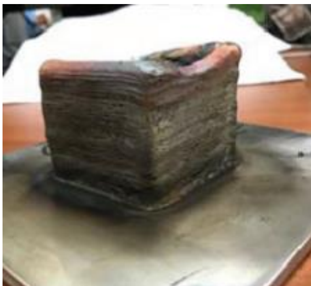
Slika 6. Komponenta od austenitnog nehrđajućeg čelika izrađena WAAM postupkom [15]
