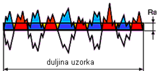
Slika 20: Način određivanja parametara R_a i R_z
