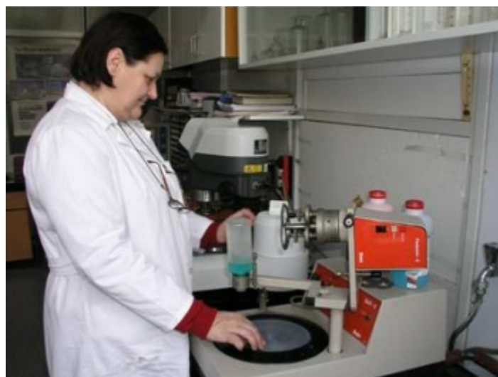
Slika 15: Brušenje referentne etalonske pločice tvrdoće
