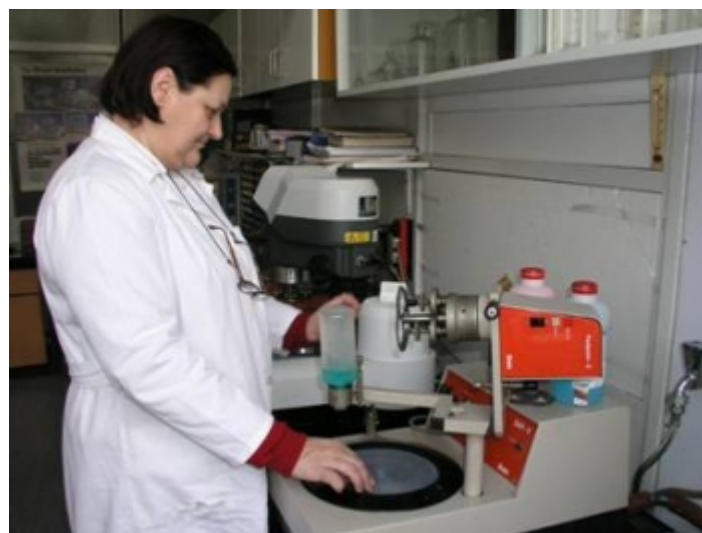
Slika 15: Brušenje referentne etalonske pločice tvrdoće
