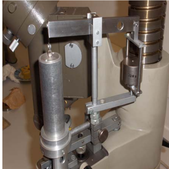
Slika 24: Polužni sustav za mjerenje mikrotvrdoće
