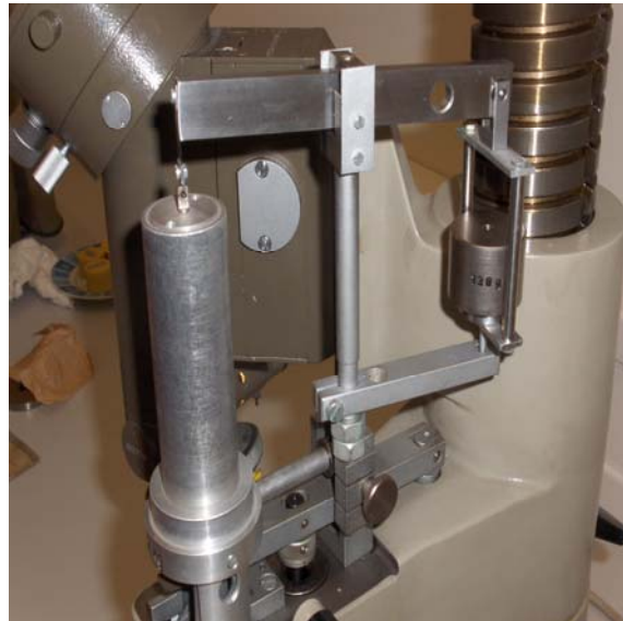
Slika 24: Polužni sustav za mjerenje mikrotvrdoće
