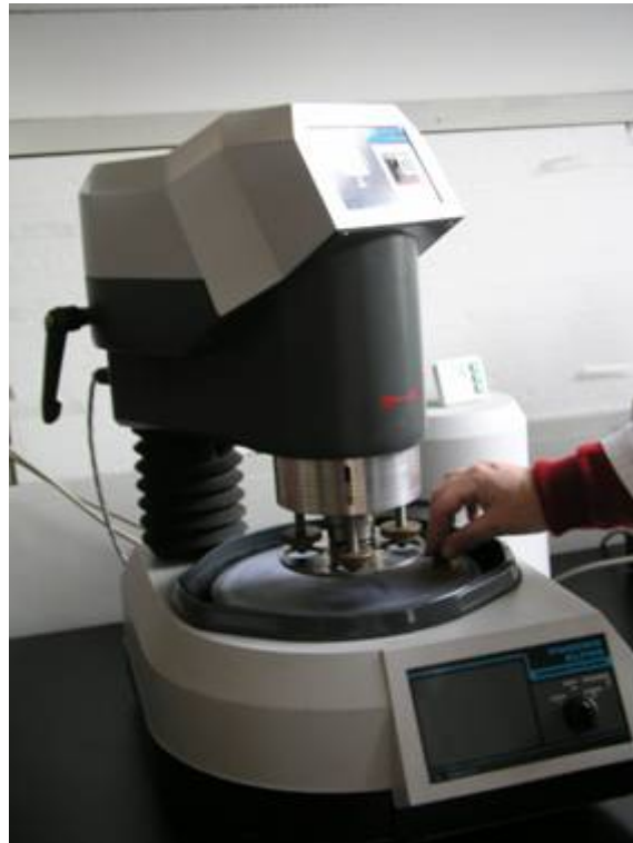
Slika 19: Poliranje referentne etalonske pločice
