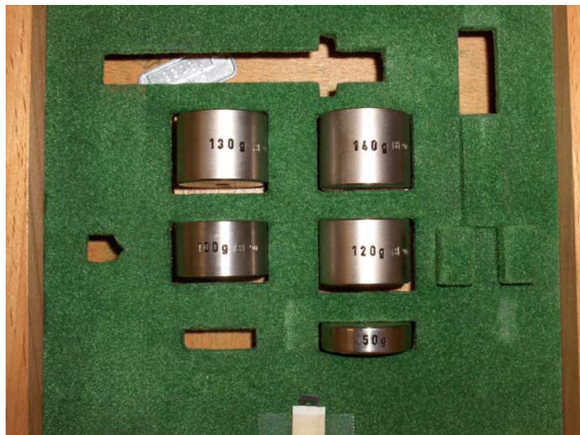
Slika 25: Utezi za mjerenje mikrotvrdoće
