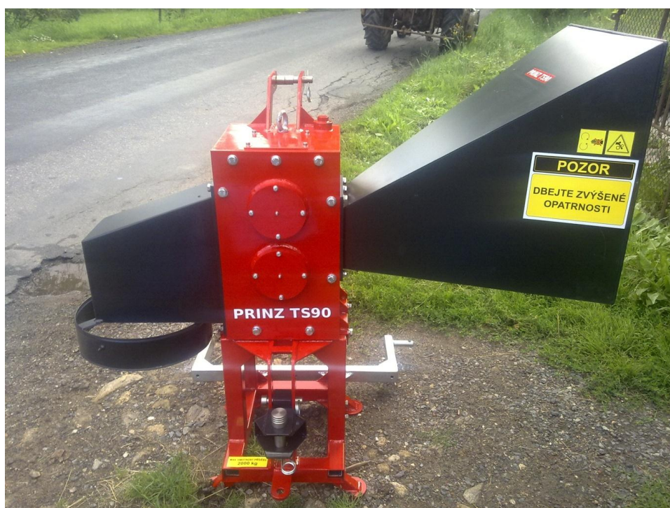
Slika 6. Uređaj za usitnjavanje drvnih ostataka Prinz TS90 [6]
