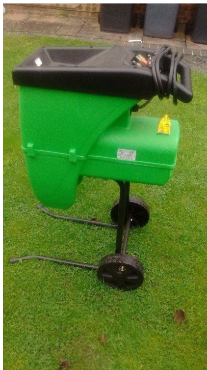
Slika 1. Električni uređaj za usitnjavanje snage 2 kW [1]
