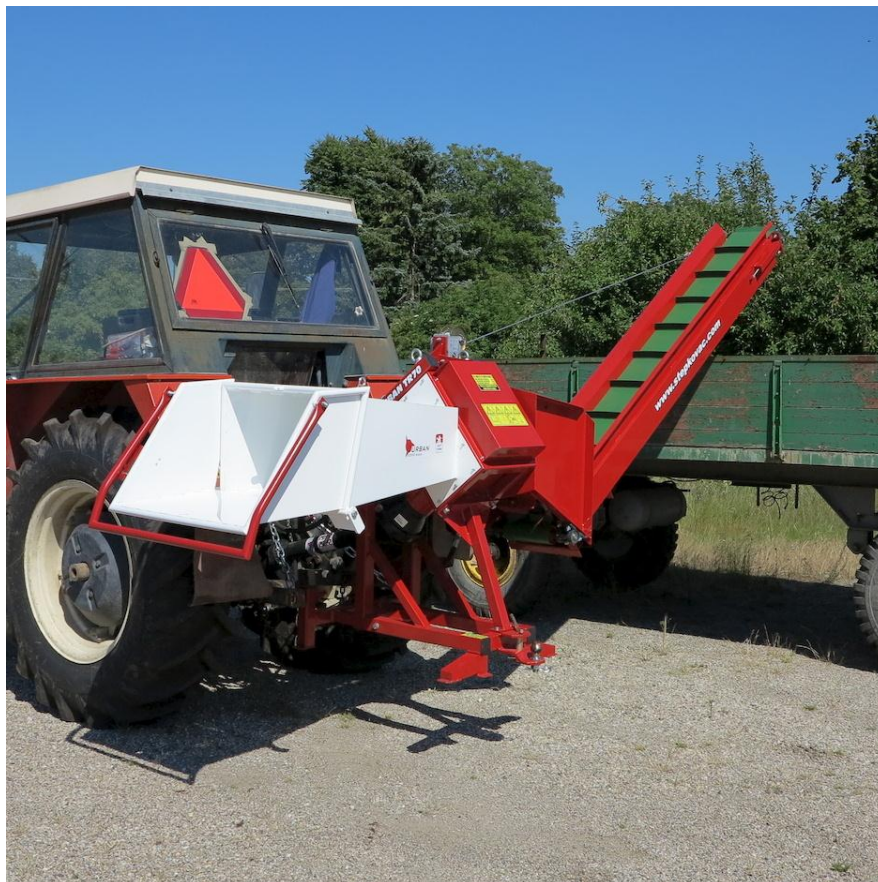
Slika 5. Uređaj za usitnjavanje drvnih ostataka Urban TR 70 [5]
