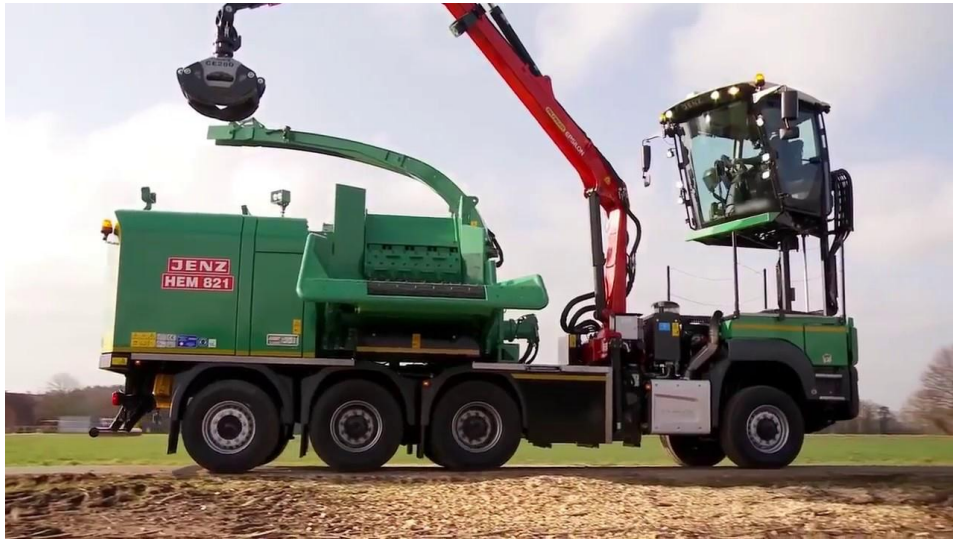
Slika 2. Uređaj za usitnjavanje drvnih ostataka velikih dimenzija [2]
