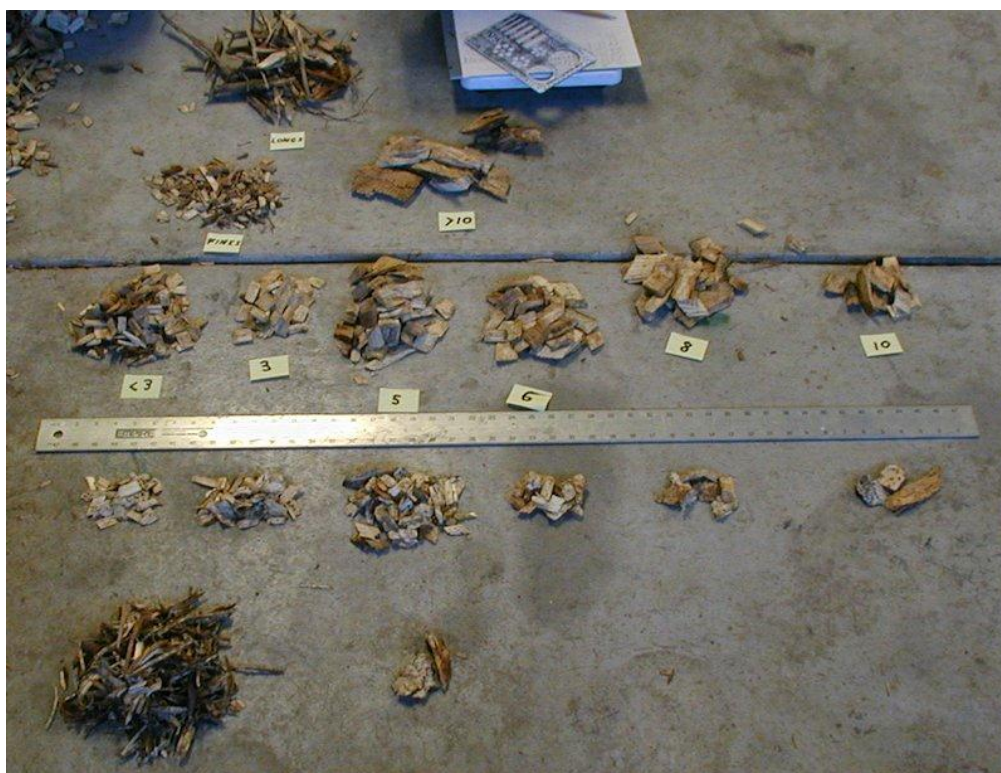
Slika 3. Usitnjeni drvni ostatci razne veličine [3]
