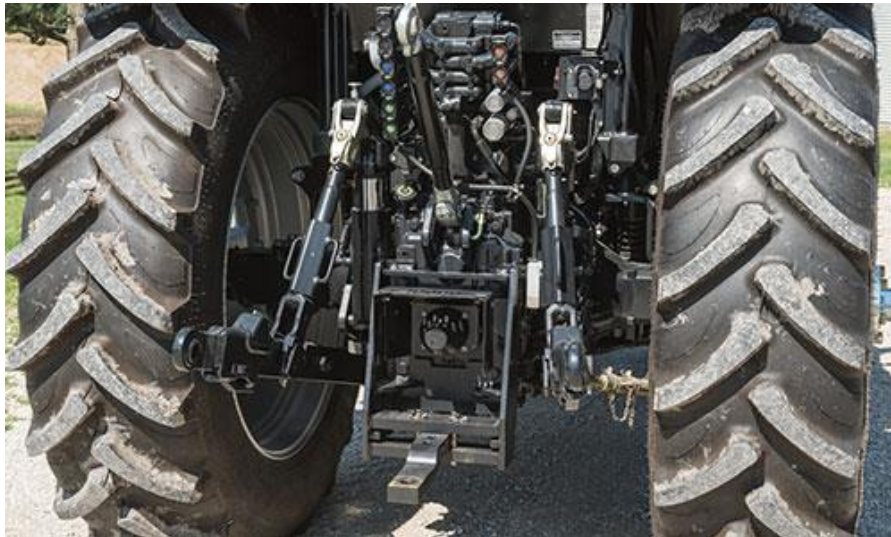
Slika 7. Traktorski priključak u tri točke [7]
