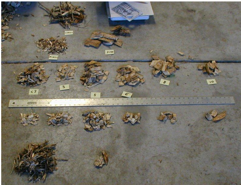
Slika 3. Usitnjeni drvni ostatci razne veličine [3]
