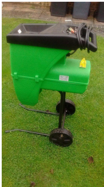
Slika 1. Električni uređaj za usitnjavanje snage 2 kW [1]
