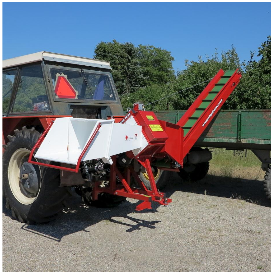
Slika 5. Uređaj za usitnjavanje drvnih ostataka Urban TR 70 [5]
