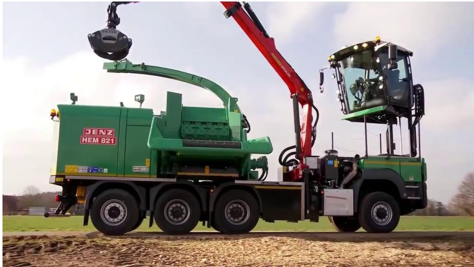
Slika 2. Uređaj za usitnjavanje drvnih ostataka velikih dimenzija [2]
