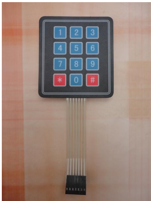
Slika 7. Matrična tipkovnica 4x3
