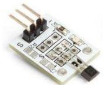
Slika 4. Hallov magnetski senzor [3]
