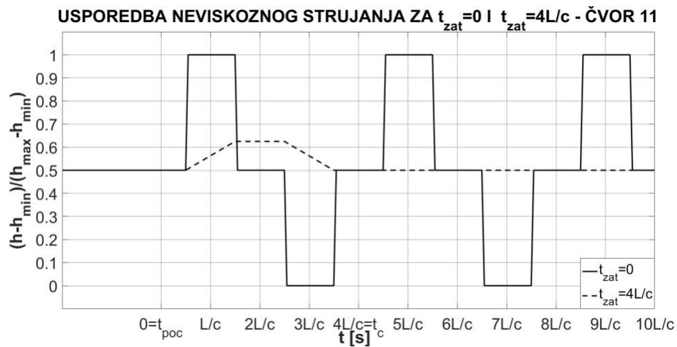
Slika 57 – Usporedba promjene piezometričke visine u čvoru 11 za vrijeme zatvaranja ventila t_{zat} = 0 i t_{zat} = 4L/c pri neviskoznom strujanju fluida
