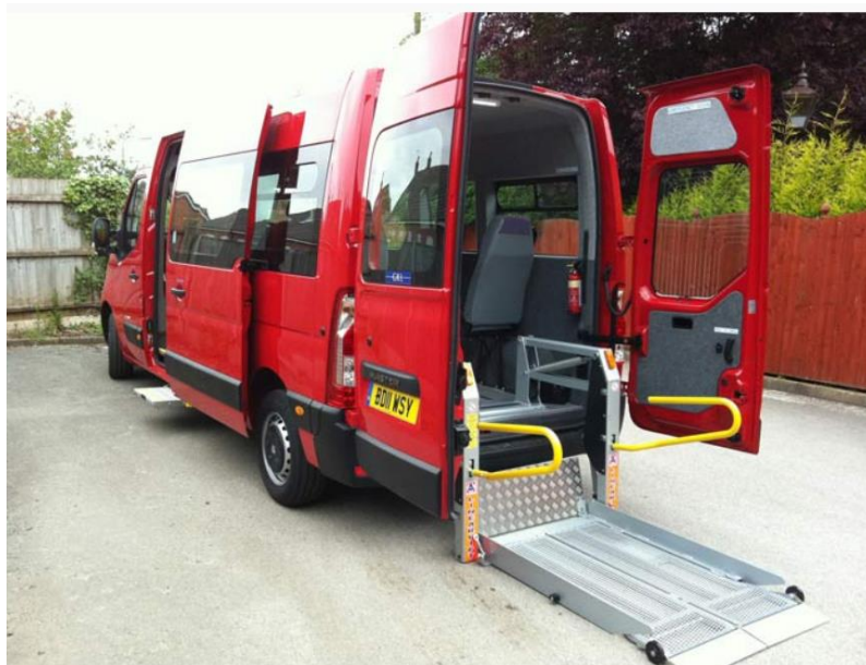
Slika 2. Minibus prerađen za prijevoz osoba s invaliditetom [4]
