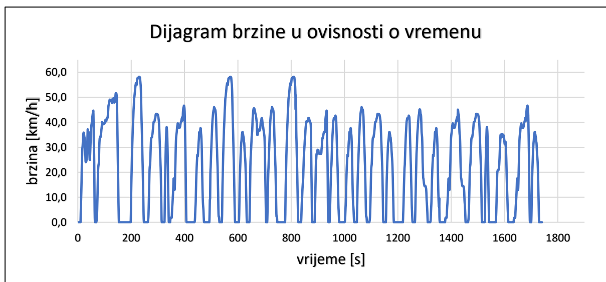
Slika 14. Dijagram brzine u ovisnosti o vremenu za Braunschweig ispitni vozni ciklus
