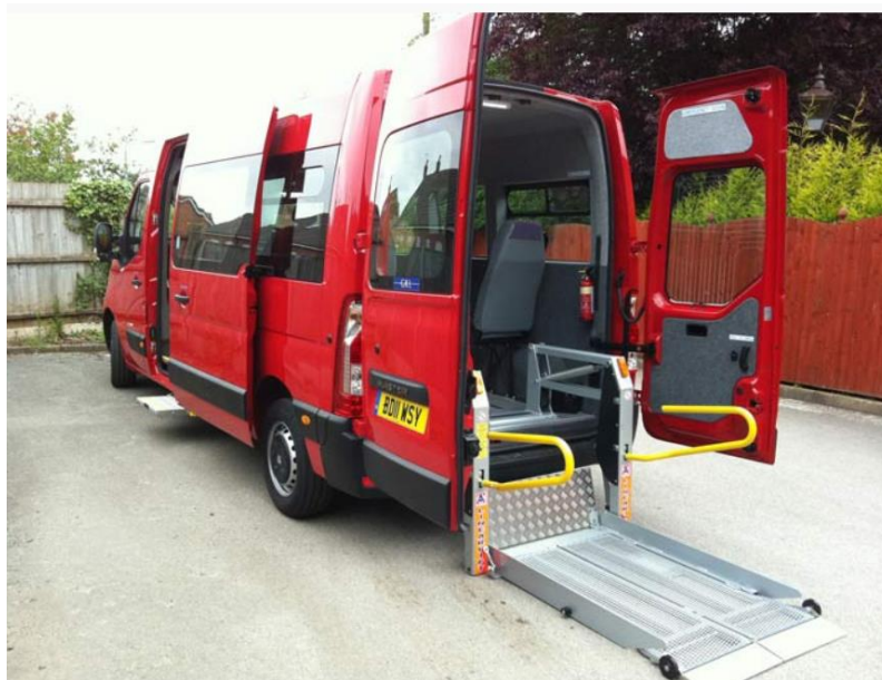
Slika 2. Minibus prerađen za prijevoz osoba s invaliditetom [4]
