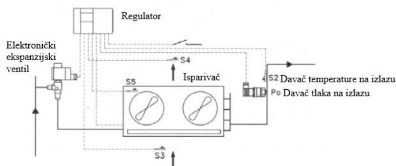
Slika 13, Elektronski ekspanzijski ventil u sustavu, [9]
