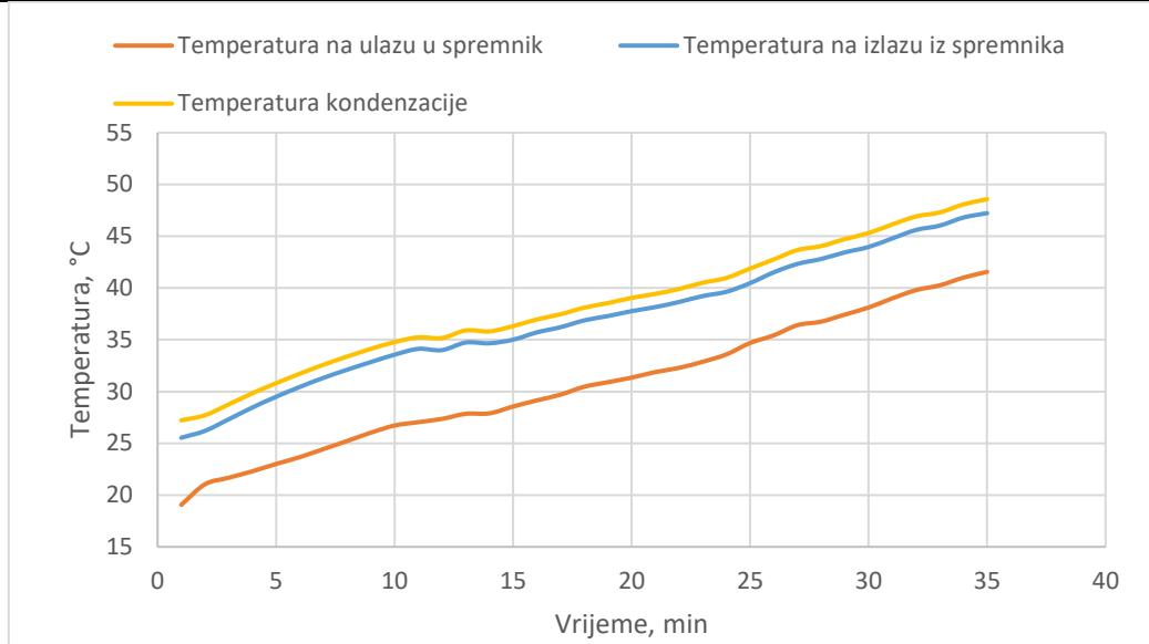
Slika 33, Temperatura glikolne smjese na ulazu i izlazu iz spremnika i temperatura kondenzacije
