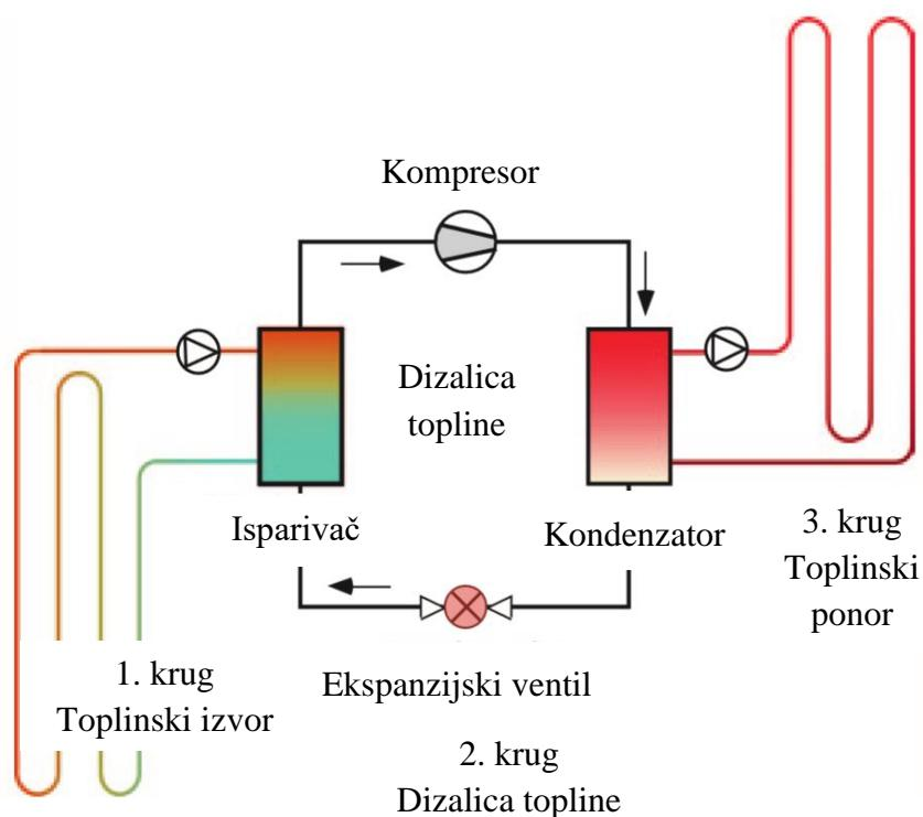
Slika 4, Shematski prikaz sustava dizalice topline, [3]
