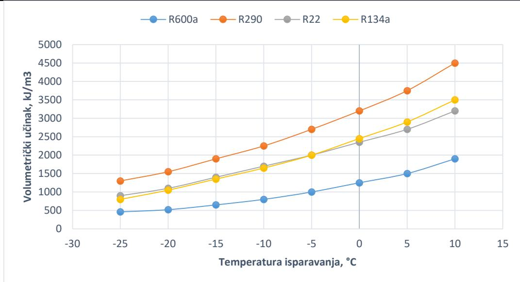
Slika 17, Volumetrički rashladni učinak radnih tvari u funkciji temperature isparivanja, [13]
