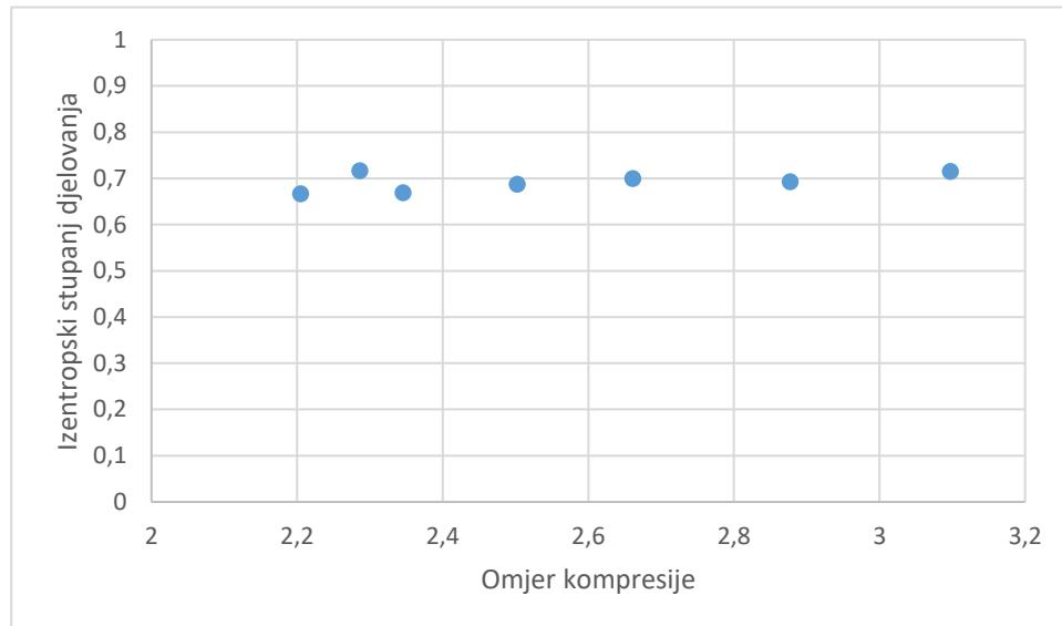
*Slika 38, Izentropski stupanj djelovanja u ovisnosti o kompresijskom omjeru*
