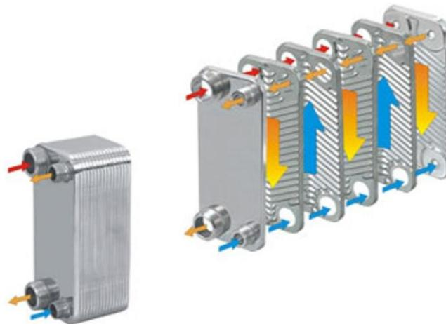
Slika 10, Pločasti izmjenjivač topline, [6]
