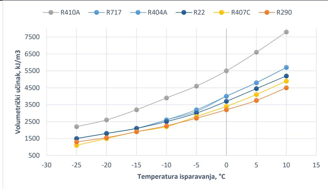
Slika 18, Volumetrički rashladni učinak radnih tvari u funkciji temperature isparivanja, [13]
