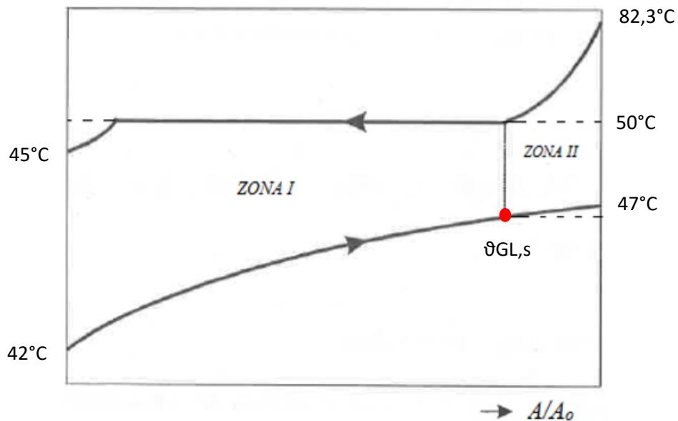
Slika 26, Dijagram izmjene topline u kodenzatoru
