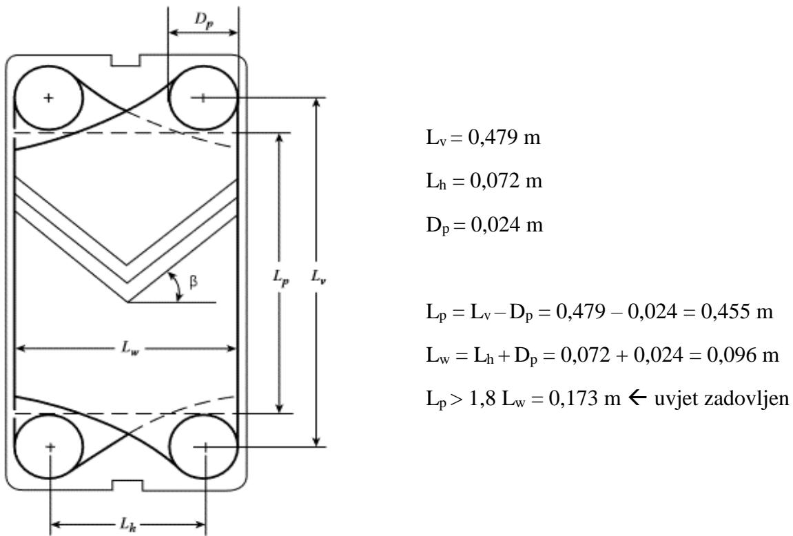
Slika 24, Geometrija ploče isparivača, [15]
