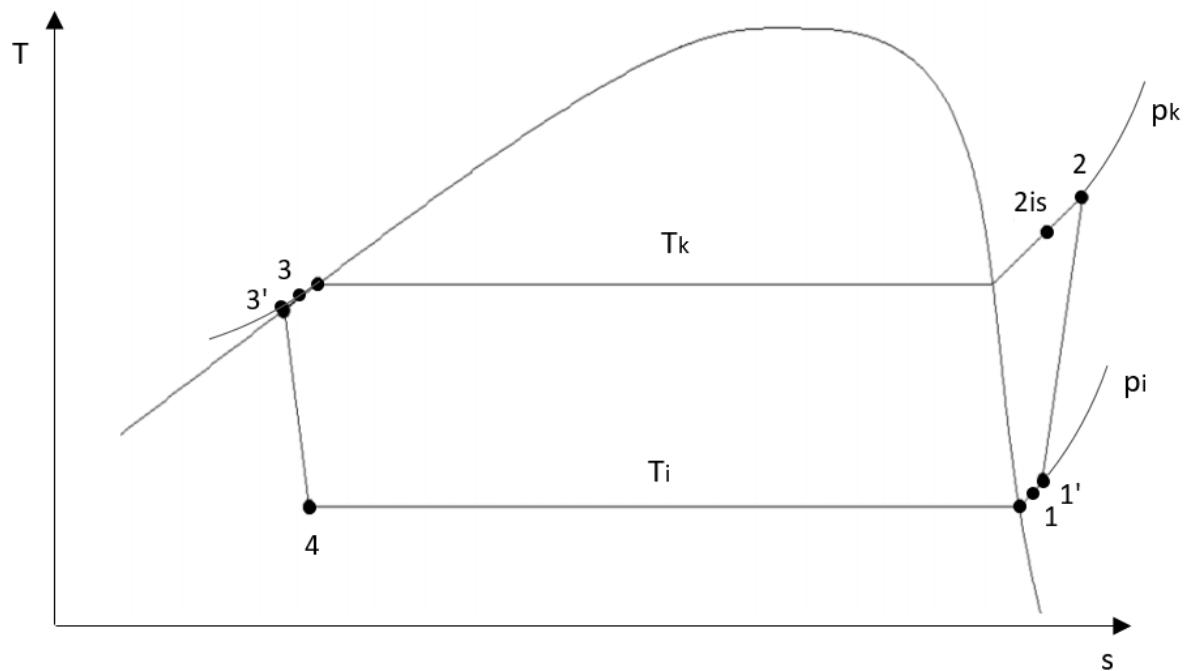
Slika 20, Prikaz ogrjevnog procesa u  $T,s$  dijagramu
