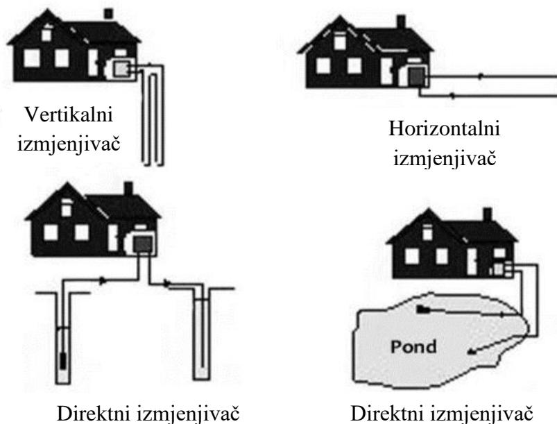
Slika 1, Geometrija izmjenjivača topline u zemlji, [1]
