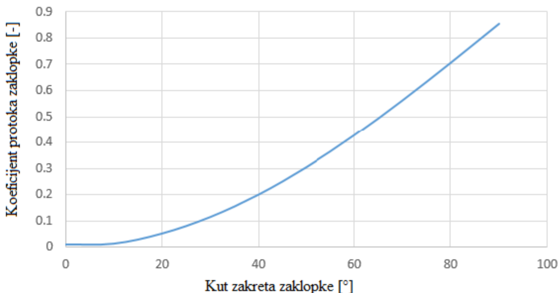
Slika 20. Koeficijent protoka zaklopke
