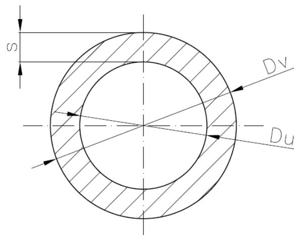
**Slika 10. Poprečni presjek nosivog stupa**
