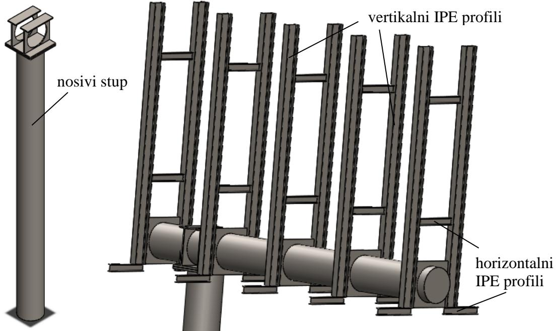
Slika 12. Modeliranje nosivog stupa i nosive konstrukcije
