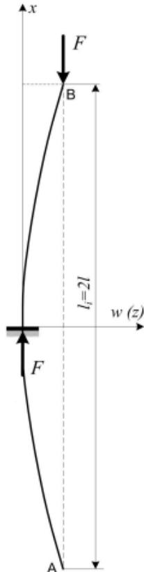
**Slika 28. Duljina izvijanja za zadan način učvršćenja stupa [20]**
