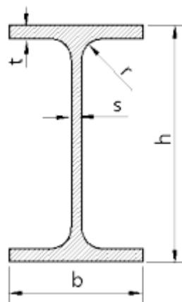
Slika 11. Poprečni presjek IPE profila s osnovnim dimenzijama [15]
