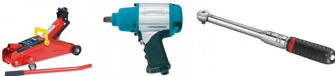
Slika 3. Hidraulička pokretna auto dizalica, pneumatski pištolj, momentni ključ
