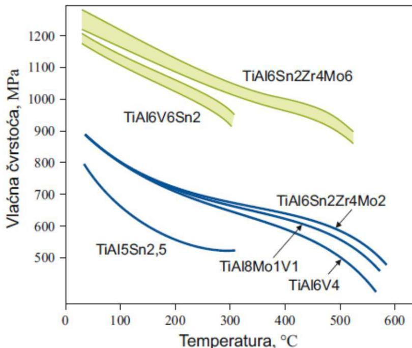
Slika 2. Vlačna čvrstoća pri povišenim temperaturama [1]
