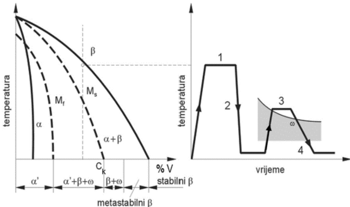
**Slika 4.** Toplinsko očvrsnuće  $\alpha+\beta$  legura titana: 1. rastopno žarenje, 2. gašenje, 3. dozrijevanje, 4. hlađenje (zrak ili voda) [1]
