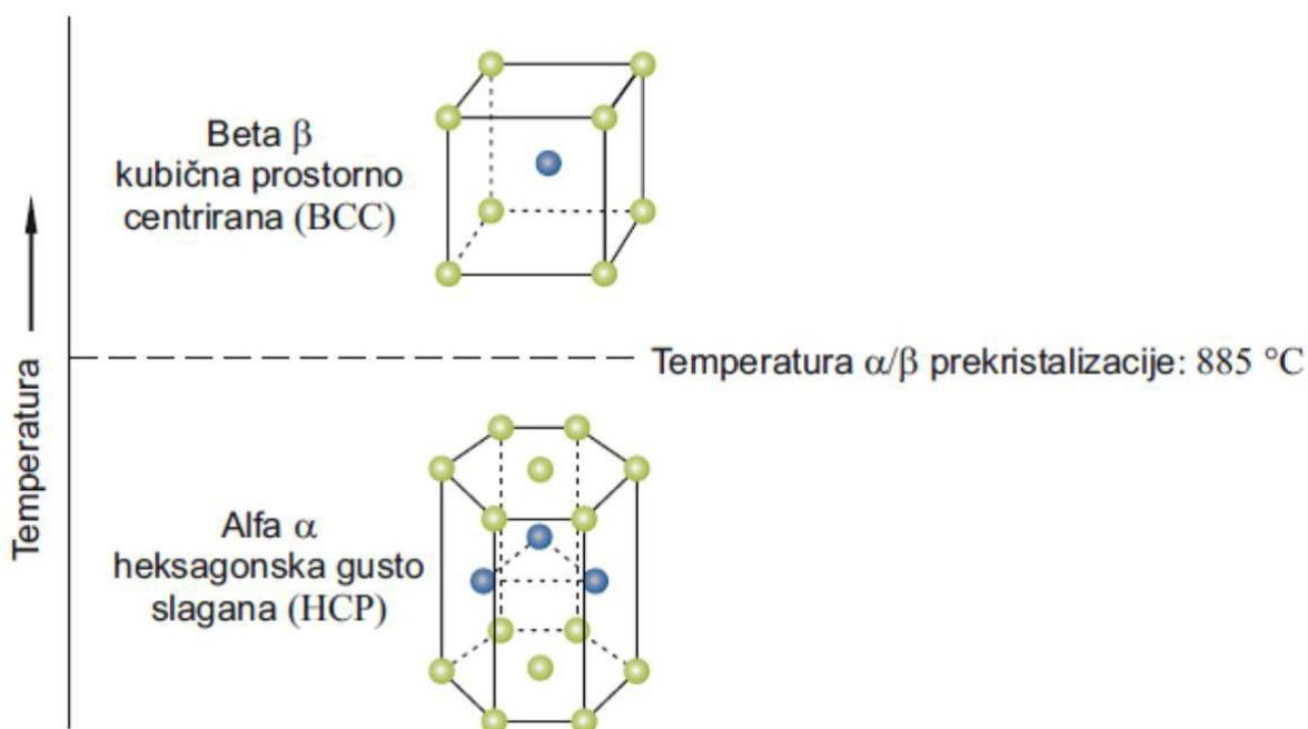
Slika 1. Struktura čistog titana [1]
