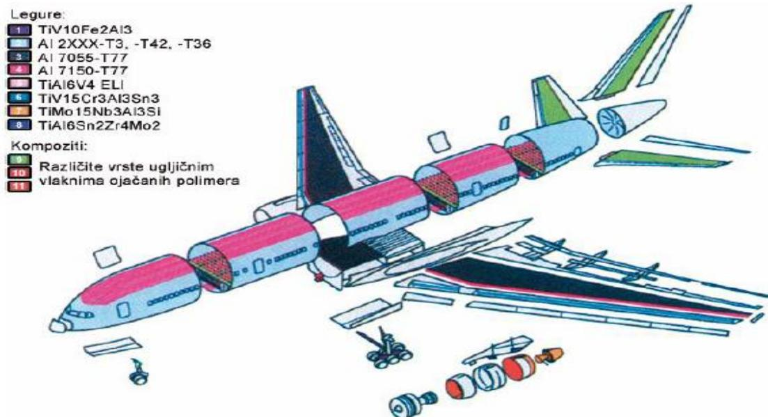
Slika 7. Konstrukcijski materijali zrakoplova Boeing 777 [1]
