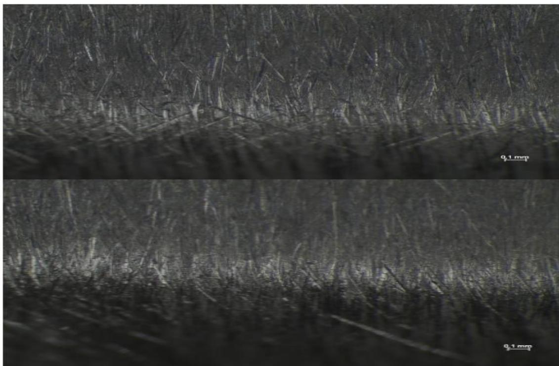
Slika 27. Površina legure nakon ispitivanja na 22 °C (gore) odnosno na 36 °C (dolje) sa uvećanjem 50x
