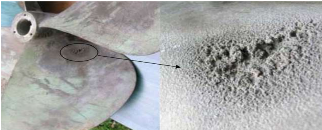
Slika 13. Kavitacijska korozija krila brodskog vijka ribarskog broda [6]
