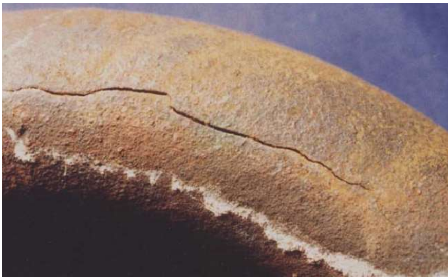
Slika 12. Primjer napetosne korozije na ugljičnom čeliku [11]
