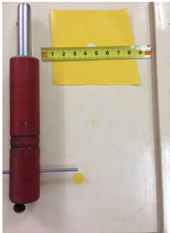
Slika 40. Mehanički uređaj za formiranje rupice
