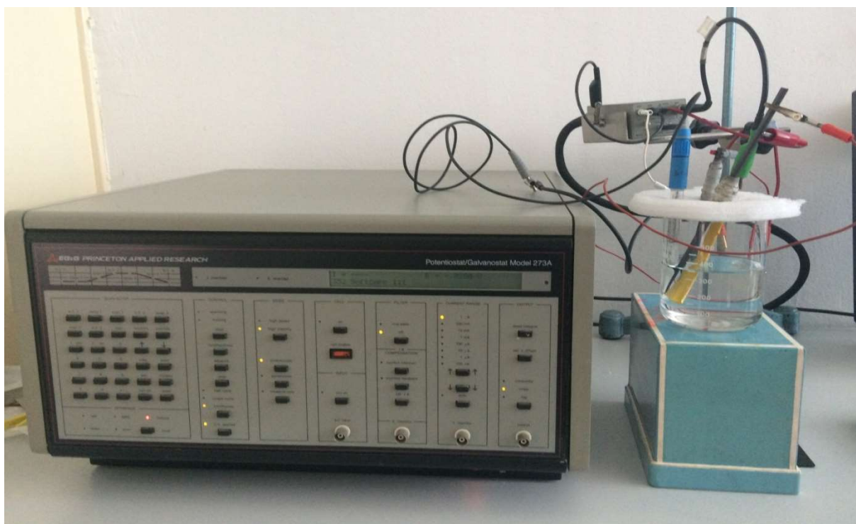
Slika 43. Potenciostat/galvanostat (model 273 EG&E)
