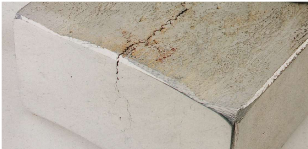
Slika 20. Napetosna korozija u aluminijskoj posudi za pohranu octene kiseline [7]
