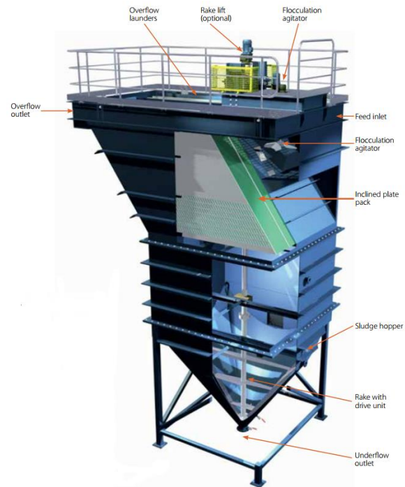
Slika 20. Presjek -Metso taložnika
