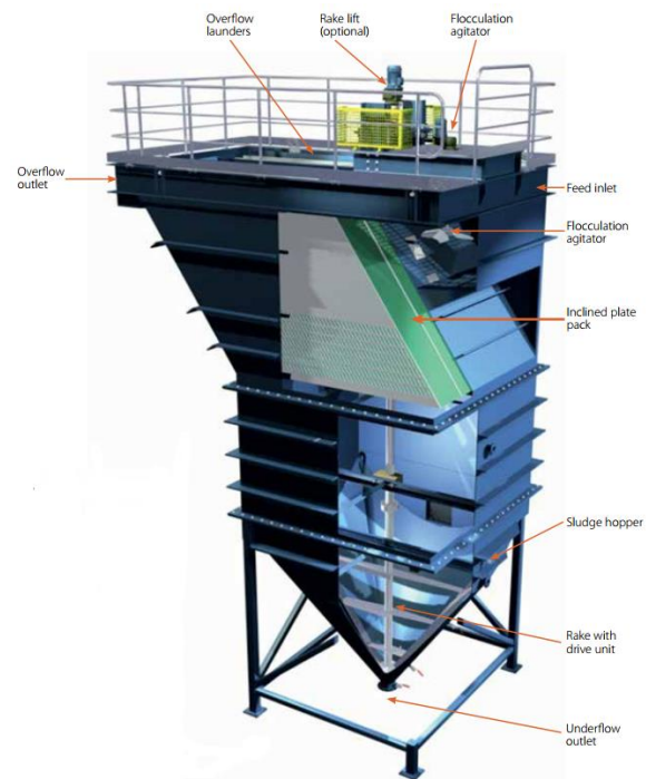
Slika 20. Presjek -Metso taložnika
