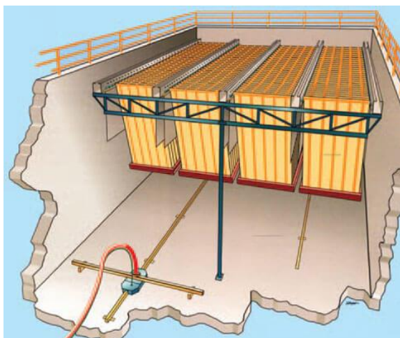
Slika 21. Montažna skica Ovivo FlexKlear taložnika
