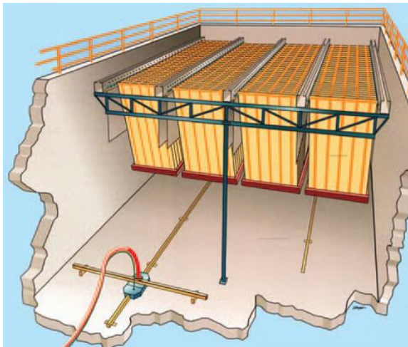
Slika 21. Montažna skica Ovivo FlexKlear taložnika
