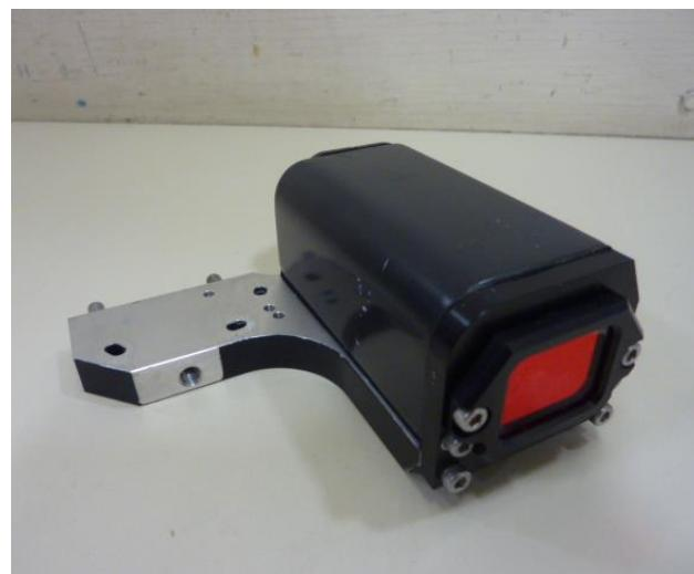
Slika 11 PS-kamera modela Fanuc A05B-1405-H036
