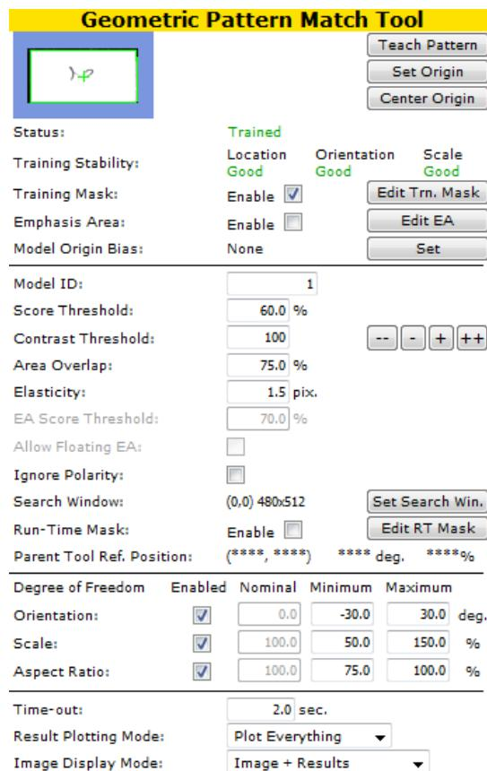
Slika 16 Izbornik alata za prepoznavanje geometrijskih uzoraka
