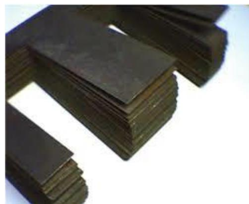
**Slika 2.** Limovi transformatora [3]
