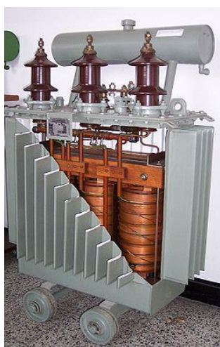
Slika 1. Trofazni distributivni transformator [2]
