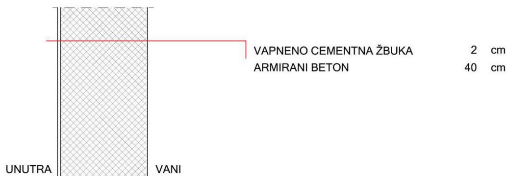
Slika 7. Sastav istočnog i zapadnog vanjskog zida [4]
