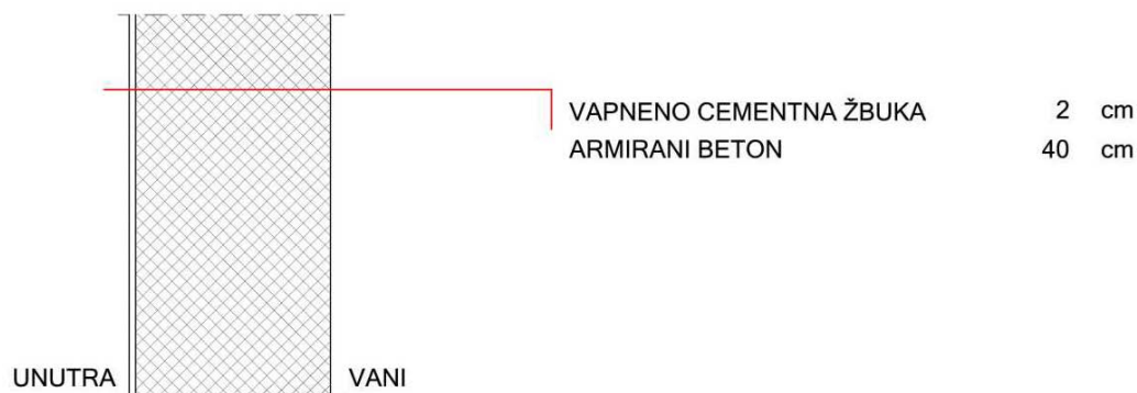
Slika 7. Sastav istočnog i zapadnog vanjskog zida [4]
