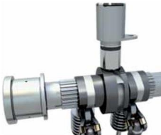
Slika 5. Trostupanjski sustav s pomičnim brijegom bregastog vratila [3]
