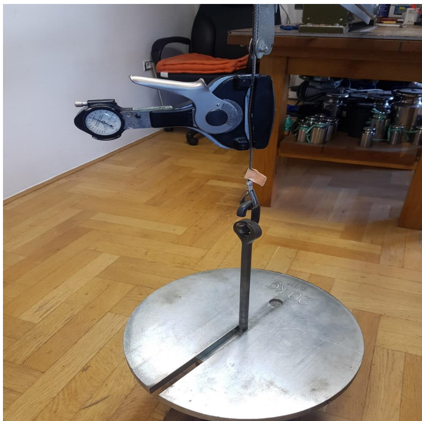
Slika 28. Mjerenje tenzometrom na čeličnoj užadi 1/8" opterećenoj utezima
