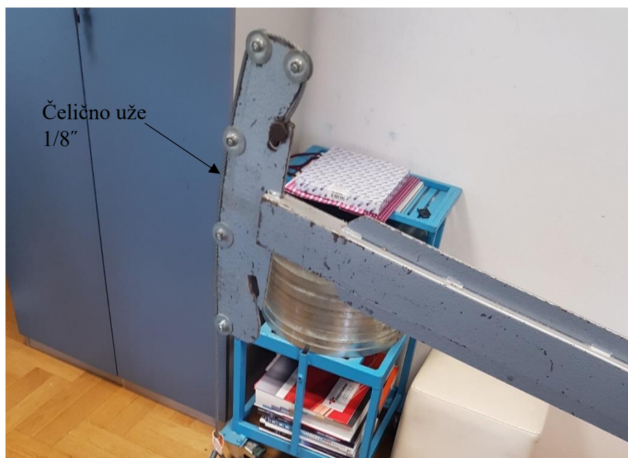
Slika 26. Čelično uže postavljeno na polugu
