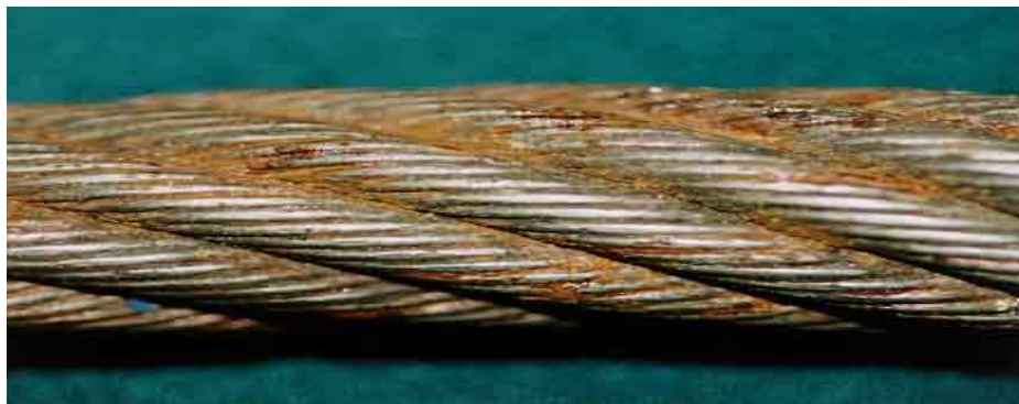
Slika 5. Korozijski oštećeno čelično uže [5]
