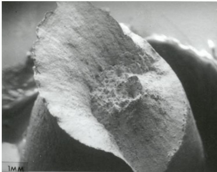
Slika 6. Tipičan duktilni lom završen konusnim smicanjem [5]
