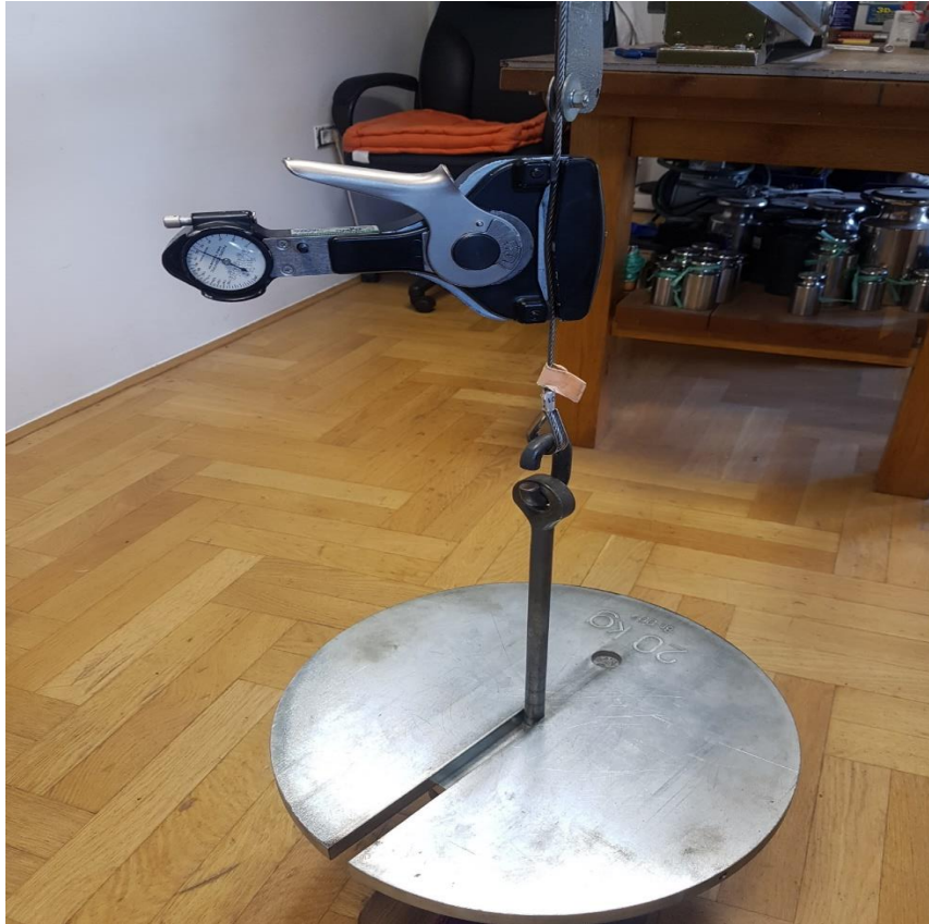
Slika 28. Mjerenje tenzometrom na čeličnoj užadi 1/8" opterećenoj utezima
