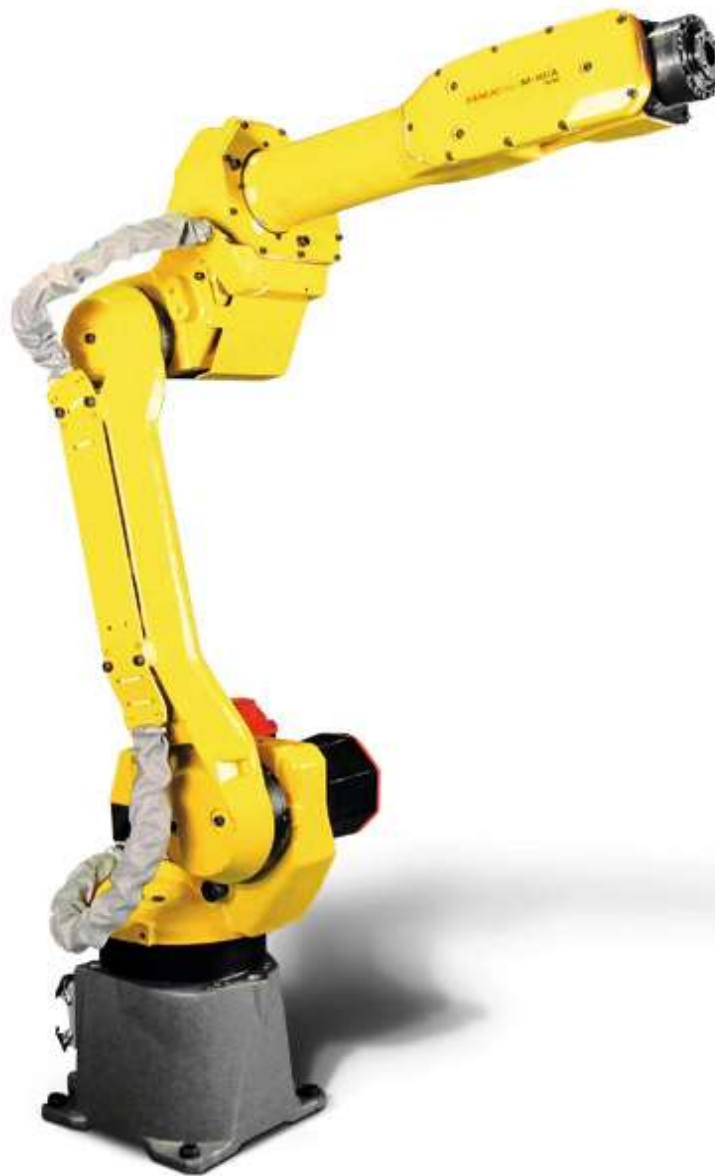
Slika 16. Industrijski robot FANUC M-10iA
