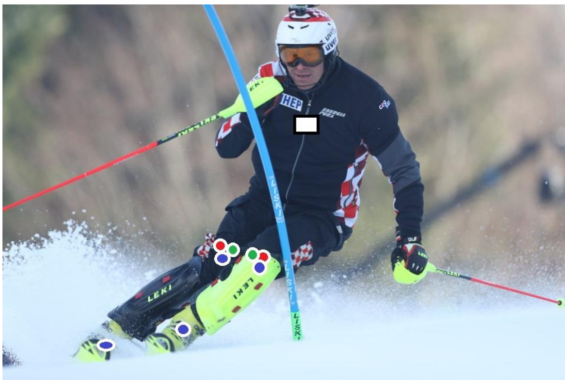
Slika 27. Položaji senzora u konceptualnom skijaškom mehatroničkom sustavu
