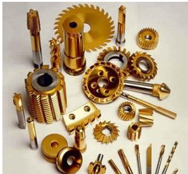
Slika 7. Rezni alati prevučeni TiN prevlakom [13]
