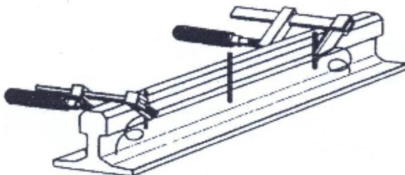
**Slika 55.** Princip postavljanja markera uzduž šine u svrhu očitanja neravnosti šine
