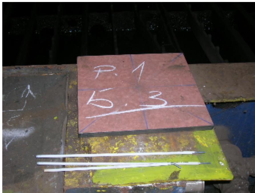
Slika 29. Kontrolni etalon sa oznakom stroja i datumom
