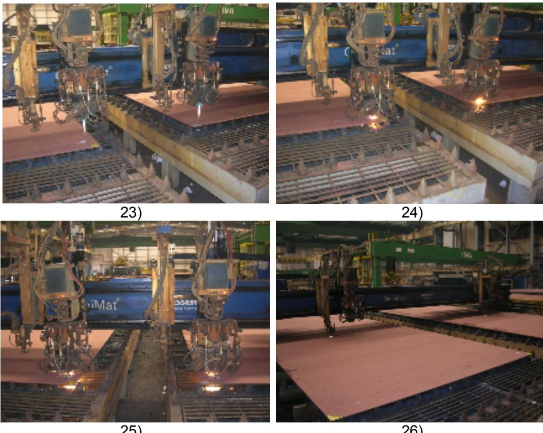
**Slike 23-26.** Rezanje limova na OXY stroju: 23) uspostava plamena,
