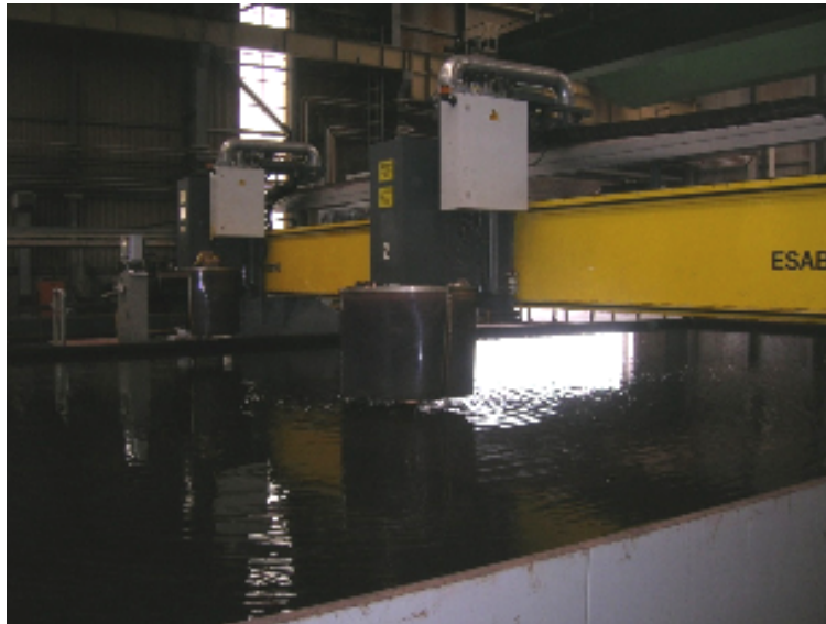
Slika 19. Rotirajuća glava za rezanje i trasiranje proizvođača Esab
