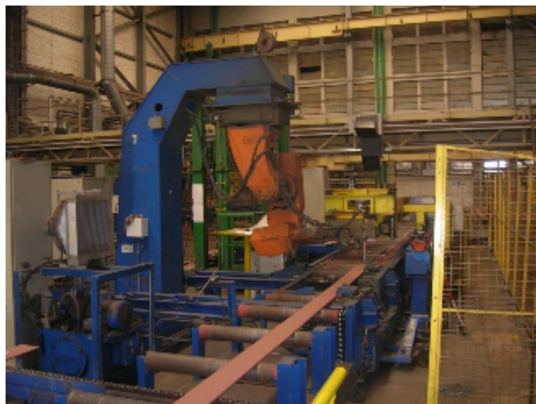
Slika 27. Robot za rezanje isključivo acetilen-kisikom
