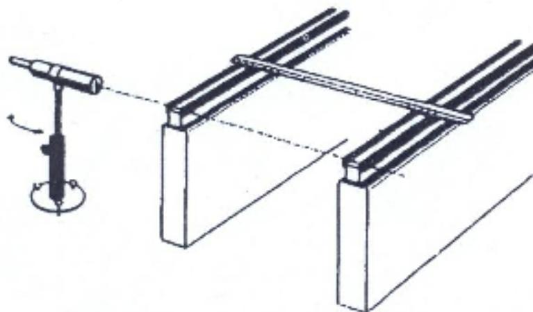
**Slika 57.** Princip mjerjenja odstupanja od horizontalnosti i paralelnosti pogonske šine i šine vodilice jedna prema drugoj
