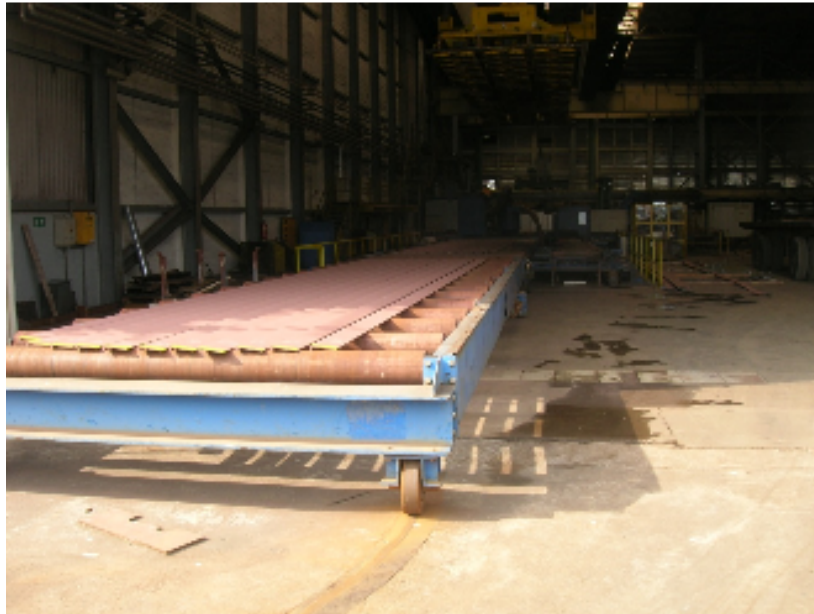
Slika 10. Okretni stol za dopremu profila na robot liniju
