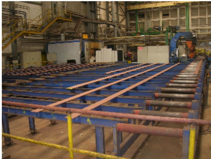
**Slika12.** Robot linija za obradu profila
