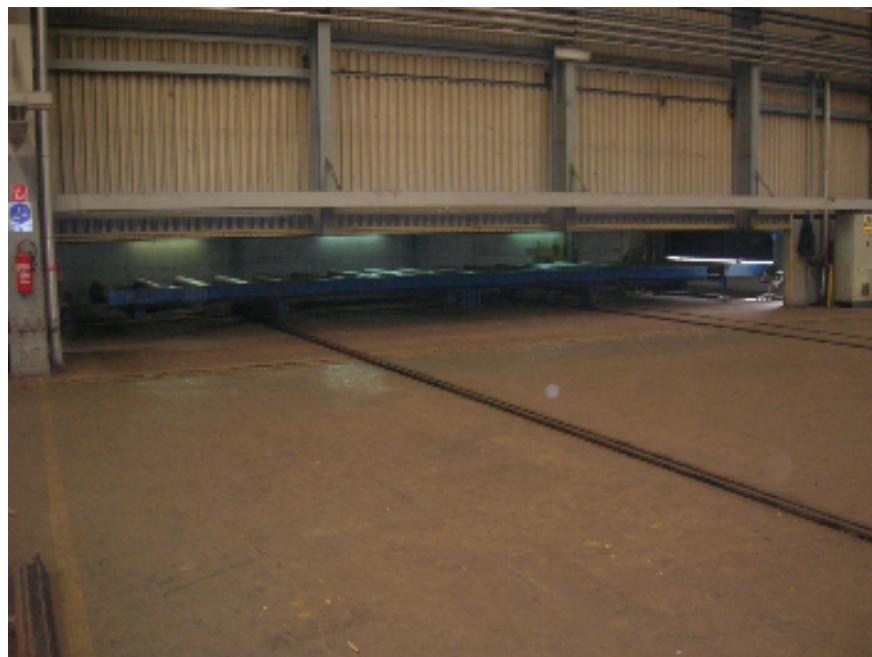
Slika 7. Poprečna rampa za unos limova u halu
