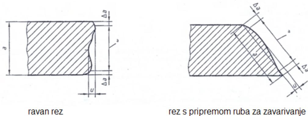
**Slika 61.** Način određivanja umanjene površine za mjerenje odstupanja u kvaliteti površine reza kod ravnog rezu i rezu s pripremom ruba za zavarivanje
