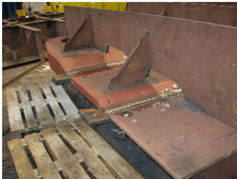
Slika 49. Prijelaz sa lima debljine 100 mm na lim debljine 20 mm
