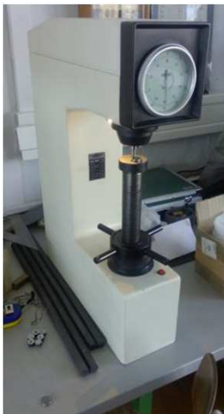
Slika 34. Trvdomjer za ispitivanje prionjivosti prevlaka
