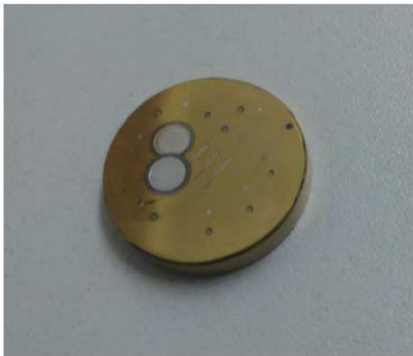
Slika 30. Uzorak prevučen TiN prevlakom
