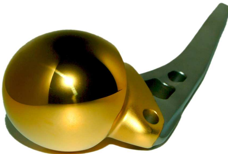
Slika 9. PVD prevlaka na medicinskom implantatu [19]
