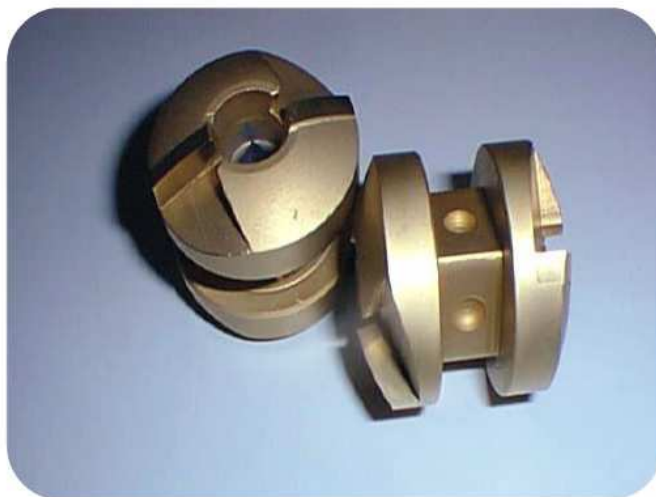
Slika 12. PACVD prevučeni alat za rezanje [29]
