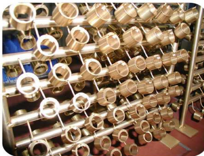
Slika 13. Prevučeni konstrukcijski dijelovi [29]
