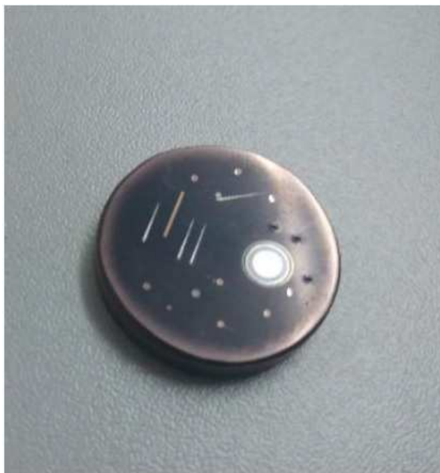
Slika 31. Uzorak prevučen TiNAlSiN prevlakom
