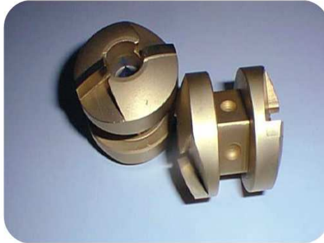
Slika 12. PACVD prevučeni alat za rezanje [29]
