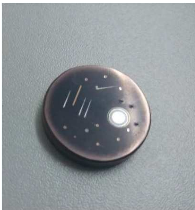
Slika 31. Uzorak prevučen TiNAlSiN prevlakom
