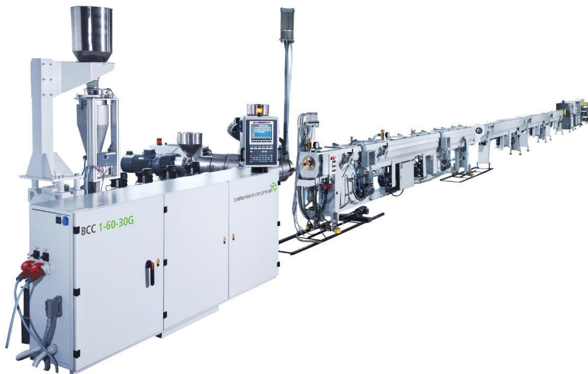
Slika 2. - Linija za ekstrudiranje 3-slojne PO cijevi, battenfeld-cincinnati [4]
