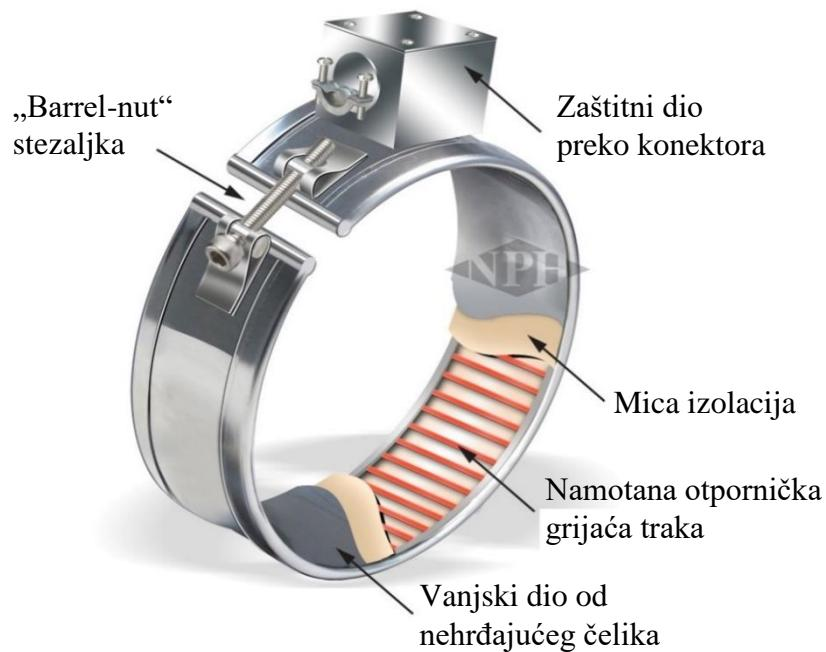
Slika 32. - Prstenasti grijajući izoliran „mica“ materijalom[7]
