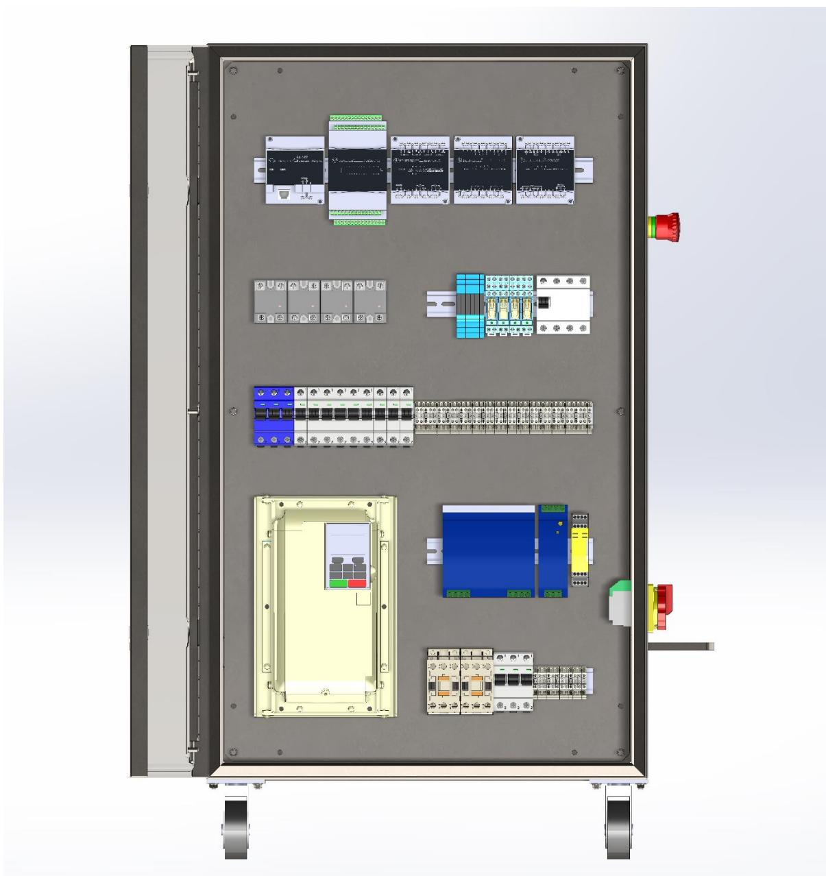
Slika 68. - Raspored komponenti u elektro ormaru
