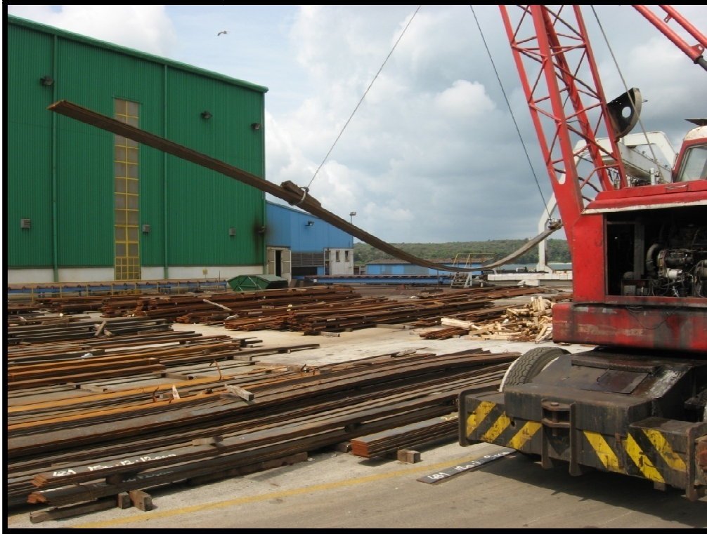
Slika 11. – Iskrivljavanje profila neadekvatnim transportom
