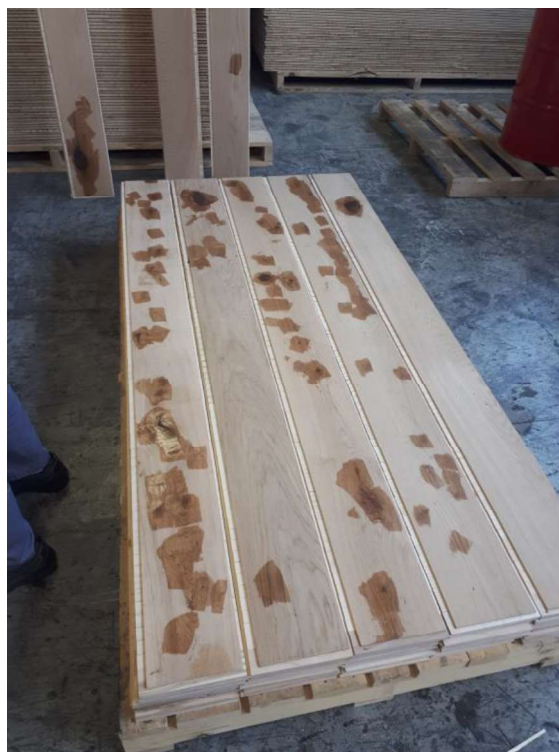
Slika 6. Parket složen na paletu nakon nanošenja punila
