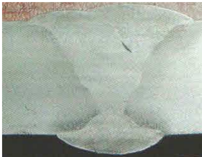
Slika 11: Naljepljivanje između slojeva zavara [10]
