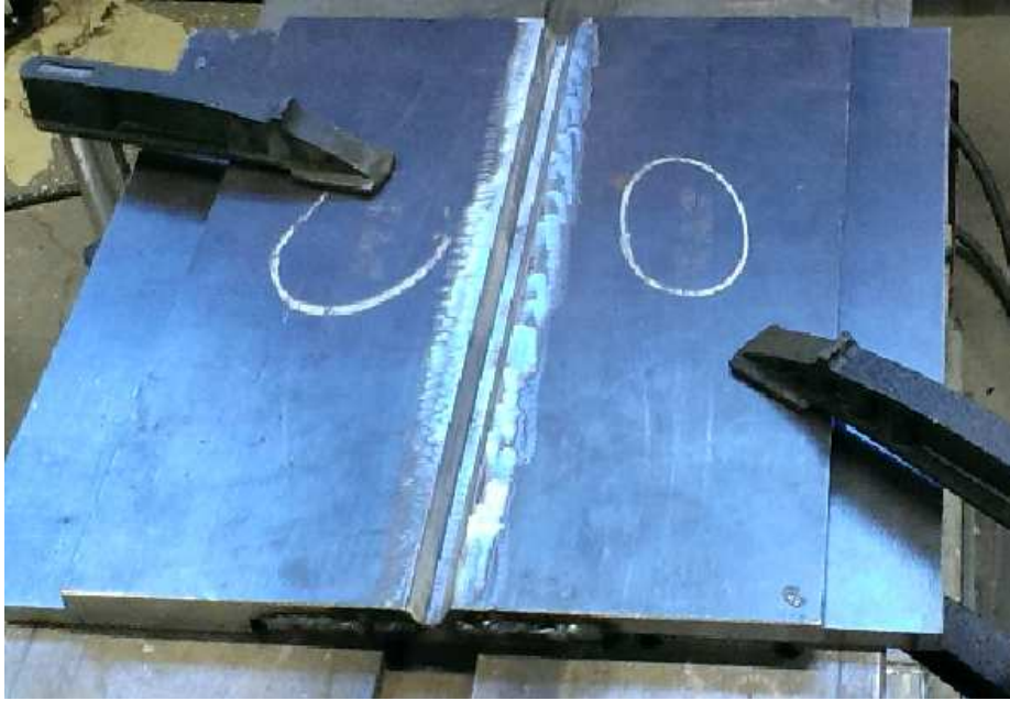
Slika 22: Pozicioniranje ploča za zavarivanje na podlozi
