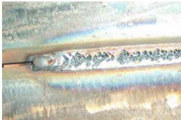
Slika 10: Pore u korijenu kod MAG zavarivanja čelika [10]
