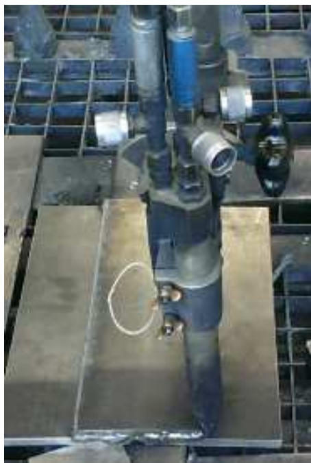
Slika 27: Reduciranje širine zavarenih ploča na plinskoj rezačici
