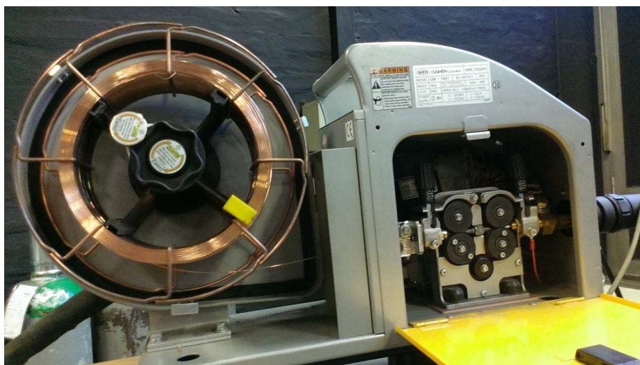
Slika 20: Kolut žice LNM MoNi i mehanizam za dodavanje žice
