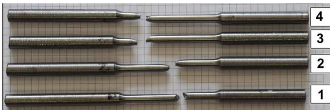
Slika 35: Epruvete nakon provedenog ispitivanja na kidalici
