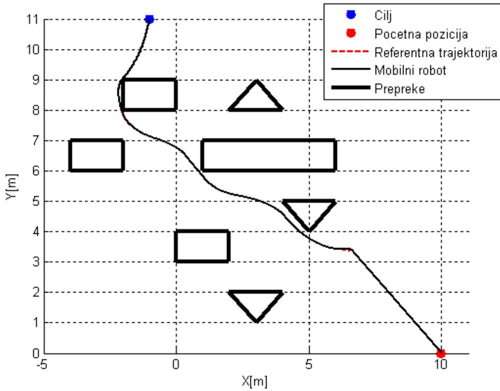
Slika 61: Gibanje mobilnog robota u radnom prostoru – 3. verzija
