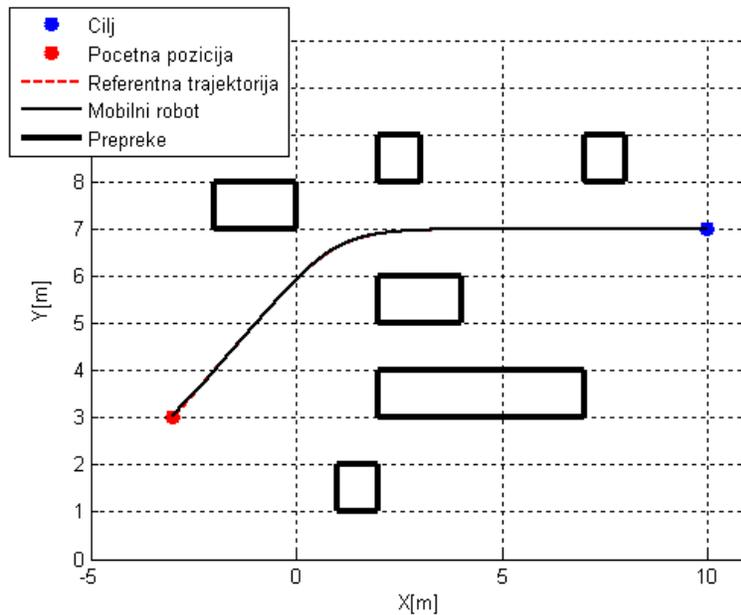
Slika 47: Gibanje mobilnog robota u prvoj simulaciji
