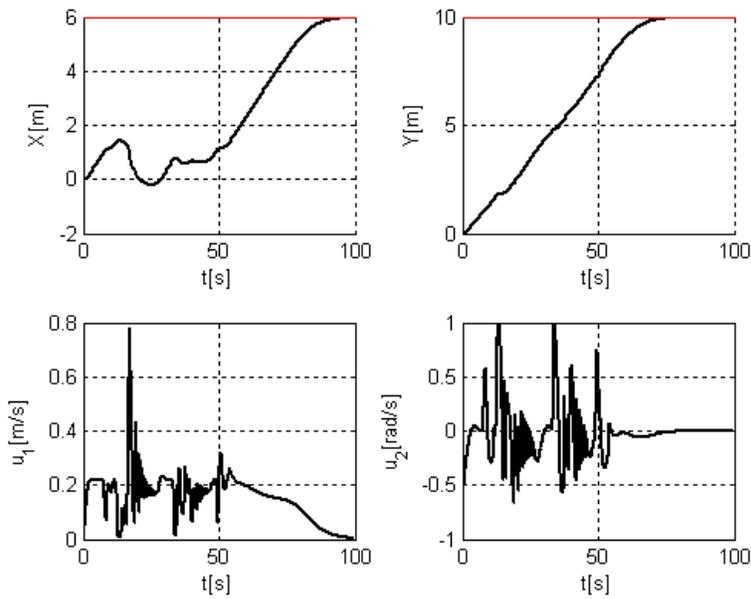
Slika 54:  $x, y$  pozicija mobilnog robota i upravljačke veličine za treću simulaciju
