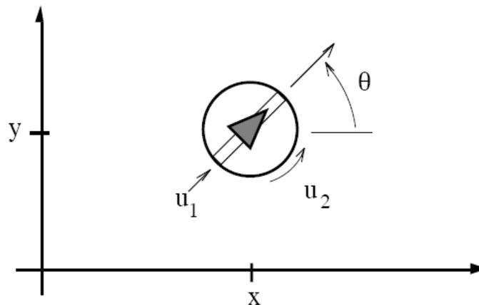
Slika 29: Model mobilnog robota s diferencijalnim pogonom
