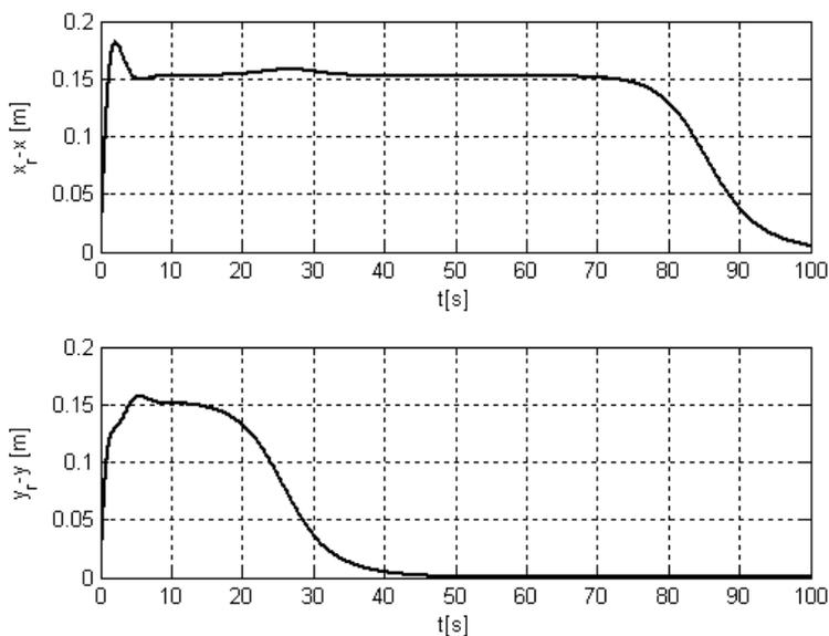
**Slika 49: Greška praćenja referentne trajektorije za prvu simulaciju**
