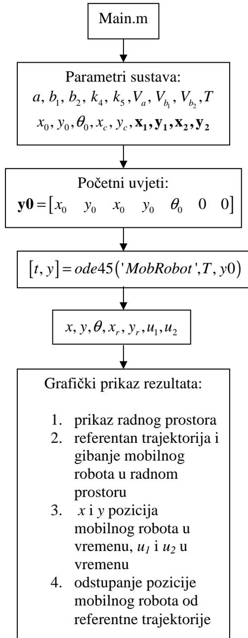
Funkcija *ode45* poziva računalni program *MobRobot* u kojemu su definirane diferencijalne jednadžbe i u kojem se detektiraju prepreke za vrijeme gibanja mobilnog
