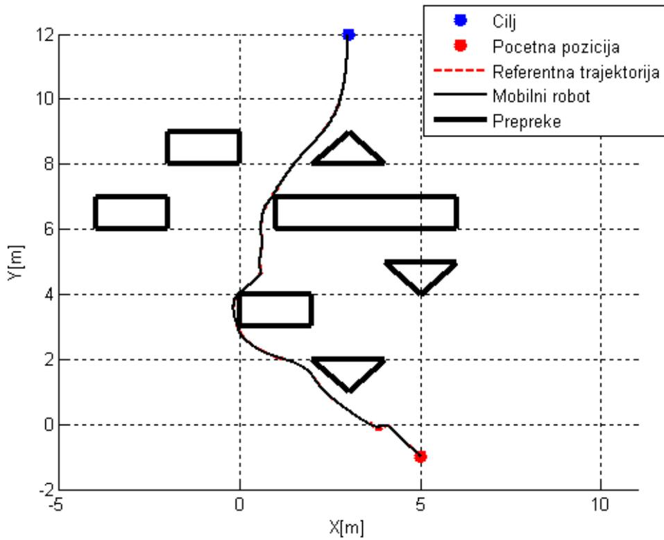
Slika 62: Gibanje mobilnog robota u radnom prostoru – 4. verzija
