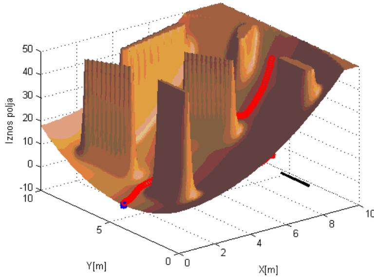
**Slika 19: Referentna trajektorija na potencijalnom polju**
