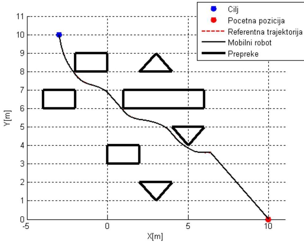
Slika 59: Gibanje mobilnog robota u radnom prostoru – 1. verzija
