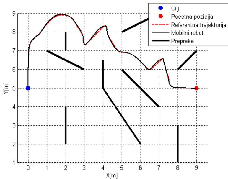
**Slika 43: Gibanje mobilnog robota u radnom prostoru**
