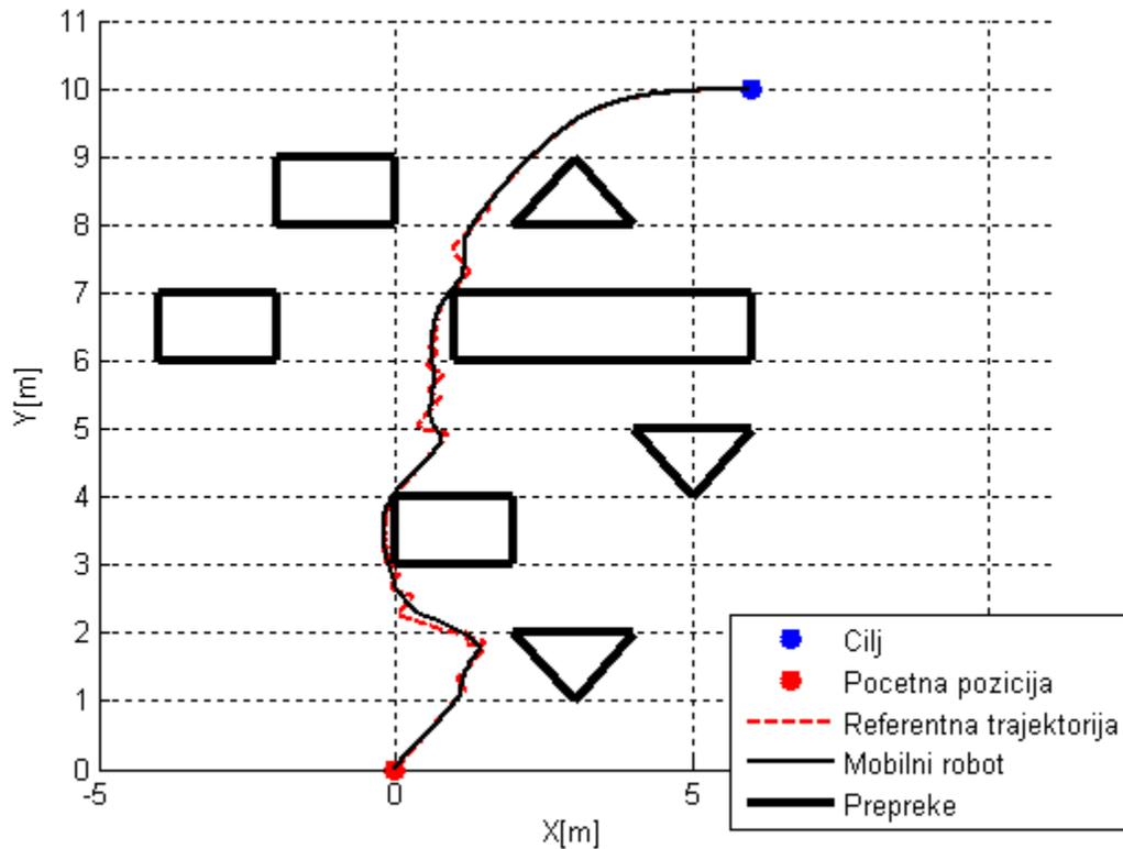
**Slika 53: Gibanje mobilnog robota u trećoj simulaciji**
