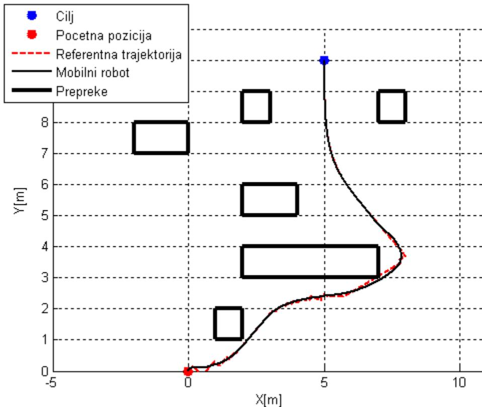
Slika 50: Gibanje mobilnog robota u drugoj simulaciji
