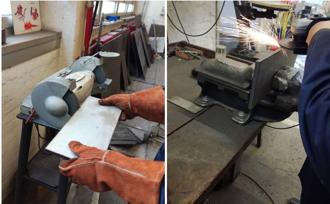
Slika 29. Lijevo - Grubo brušenje na stolnoj brusilici; Desno - Završna fina obrada kutnom brusilicom
