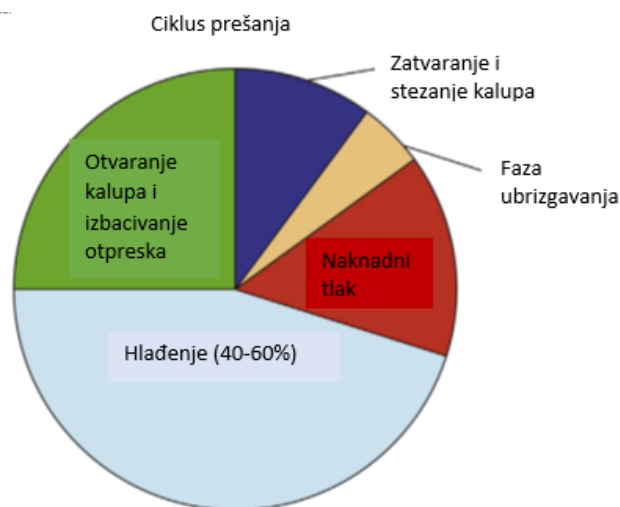
Slika 2.5: Vremensko trajanje faza tipičnog ciklusa procesa injekcijskog prešanja [2]
