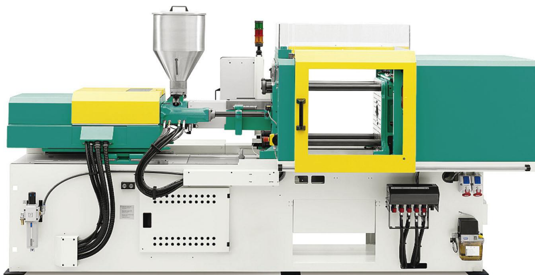
Slika 2.1: Stroj za injekcijsko prešanje [2]
