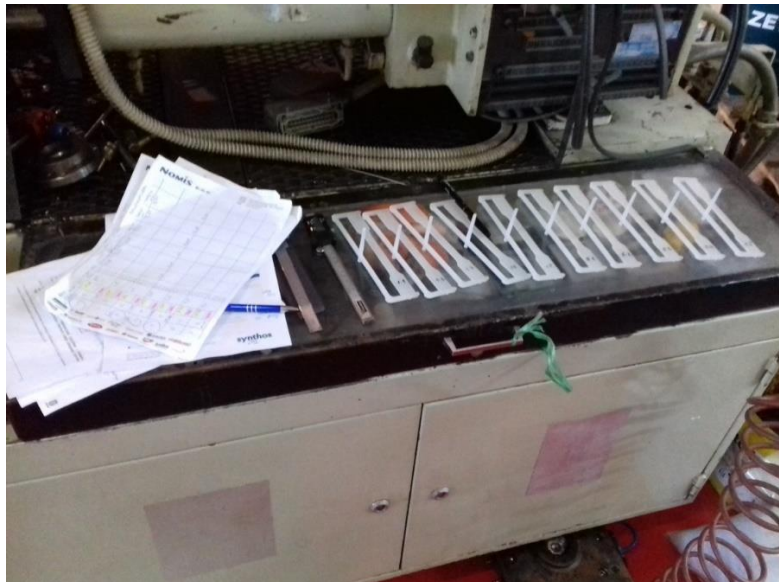
Slika 7.12: Prva ispitna tijela dobivena smanjenjem brzinom ubrizgavanja na minimalnu
