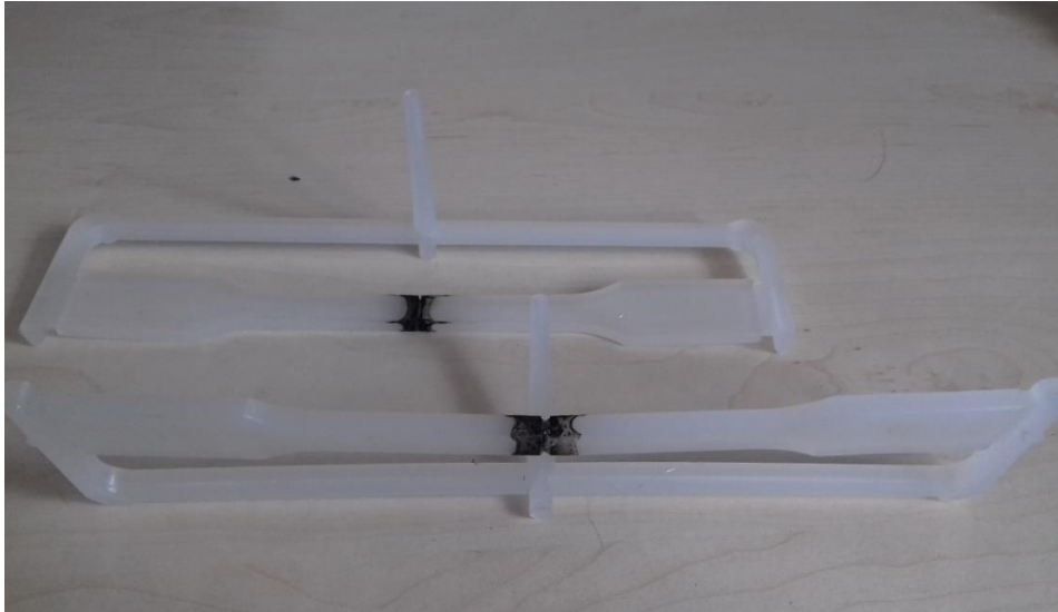
Slika 7.11: Problemi s linijom spoja dva toka taljevine sa suprotnih krajeva pri većoj brzini ubrizgavanja
