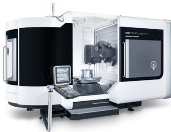
Slika 18. Petoosni glodaći obradni centar DMG MORI 125 FD duoBLOCK [12]
