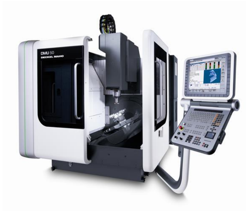
Slika 16. Petoosni glodači obradni centar DMG MORI 50 [12]
