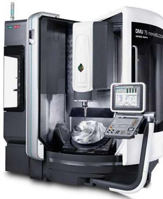
Slika 15. Petoosni glodaći obradni centar DMG MORI monoBLOCK 75 [12]
