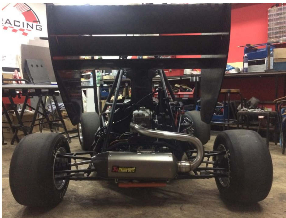
Slika 67. Novi ispušni sustav na bolidu Strix R
