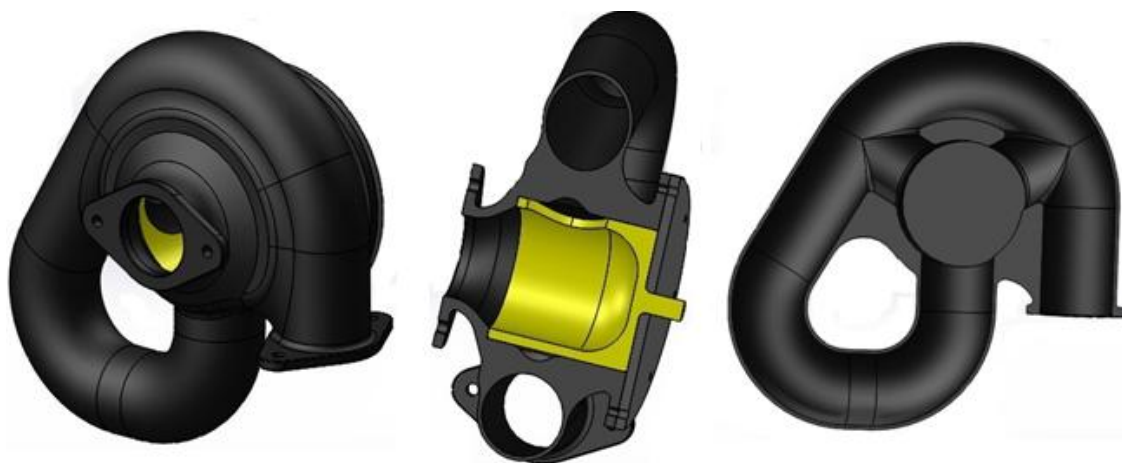
Slika 25. CAD model varijabilnog usisa s tri duljine cijevi: pogled sprijeda (lijevo), poprečni presjek, pogled sa strane (u sredini), poprečni presjek, pogled od iza (desno)
