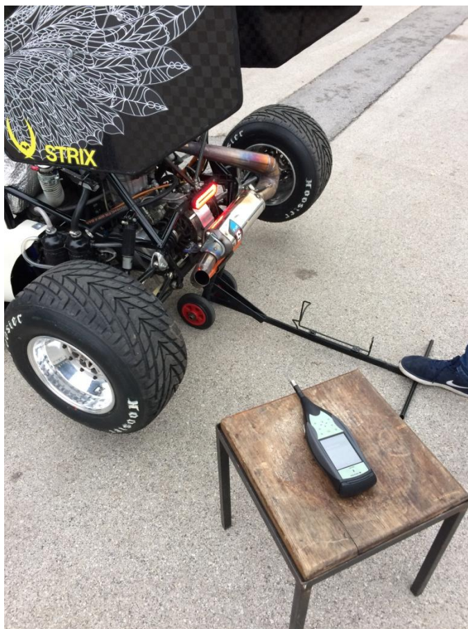
Slika 7. Postupak mjerenja buke pomoću bukomjera
