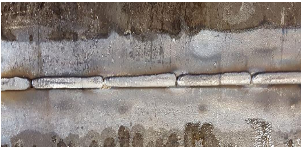
Slika 47. Diskontinuitet korijena zavara
