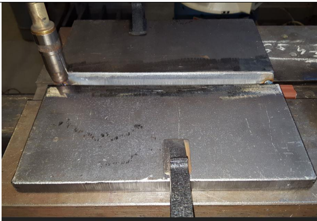
Slika 39. Pozicioniranje uzorka za MAG postupak zavarivanja
