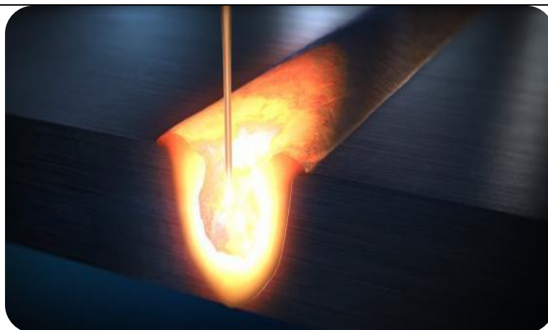
Slika 16. Zakopani električni luk, prikaz procesa iznutra [1]
