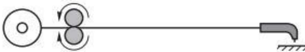
Slika 10. Dodavanje žice push sustavom [26]
