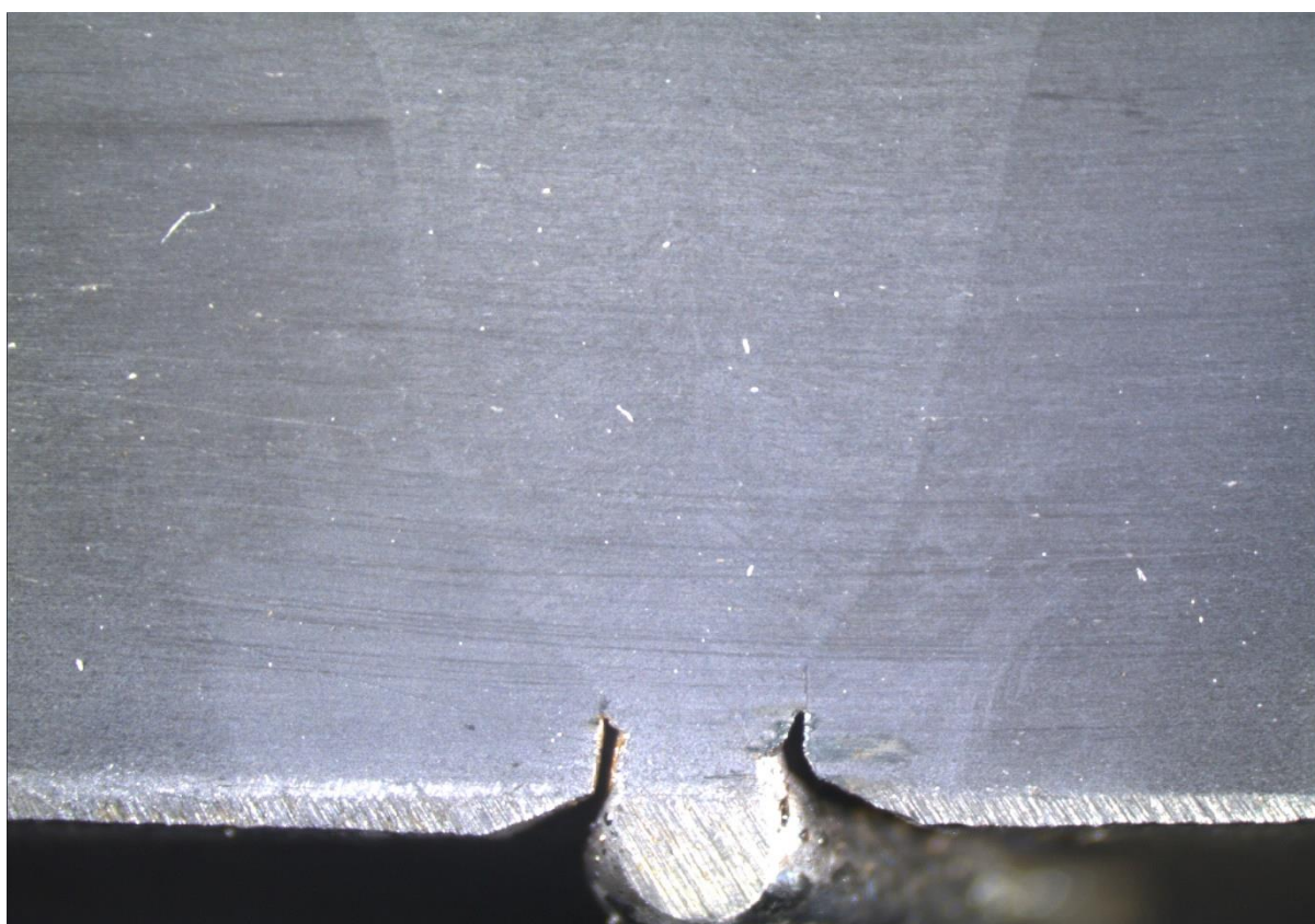
Slika 59. Makroizbrusak 3 – korijen zavara
