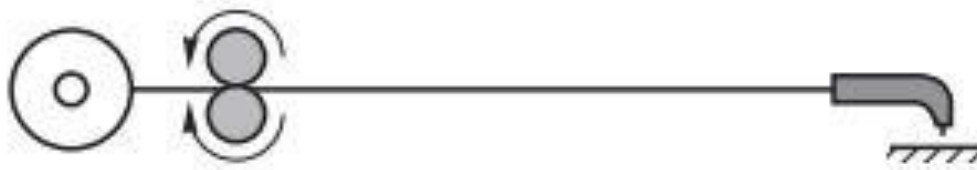
Slika 10. Dodavanje žice push sustavom [26]
