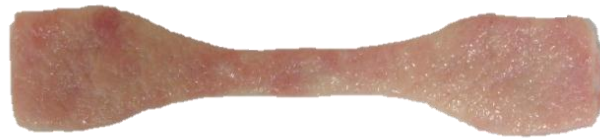
Slika 15 Uzorak za statičko vlačno ispitivanje
