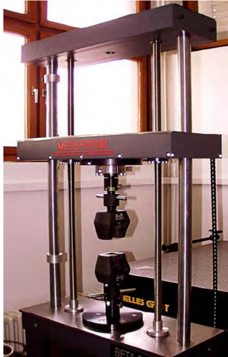
Slika 32 Statička kidalica Messphysik Beta 50-5
