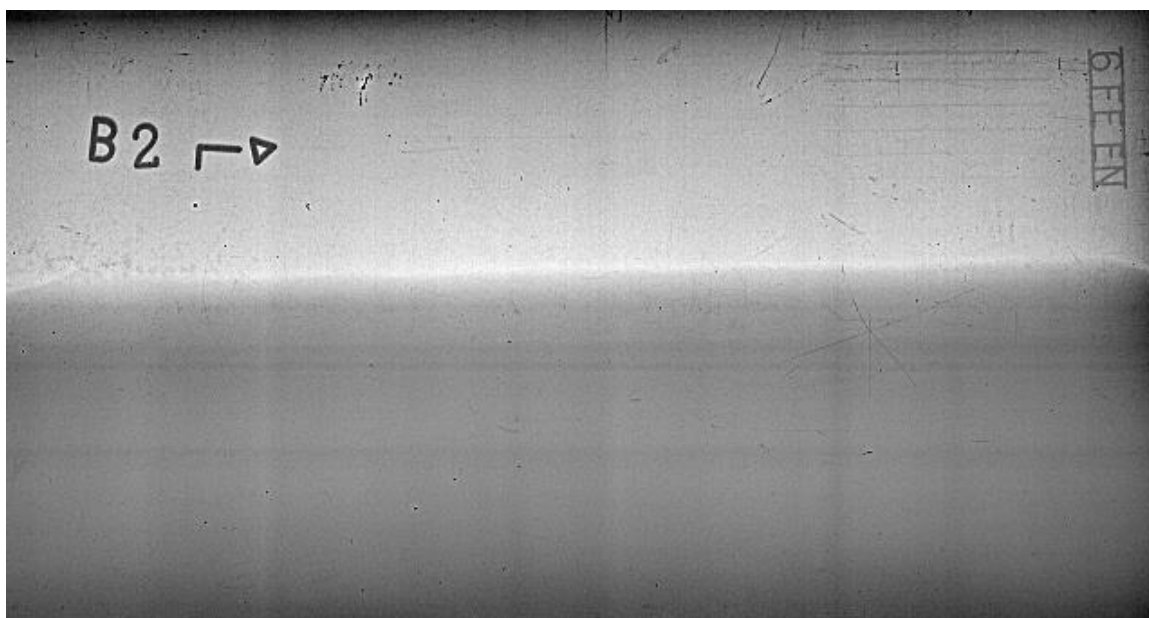
Slika 33. Radiogram zavara izveden konvecnionalnim Mag postupkom (strana B2)
