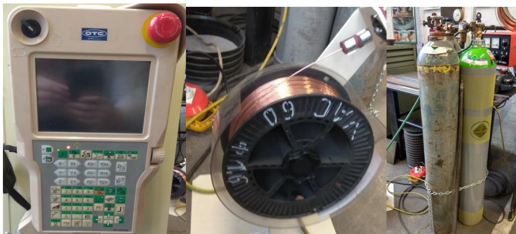
Slika 23. Privjesak za učenje (lijevo), kolut žice (sredina) i spremnici zaštitnog plina (desno)
