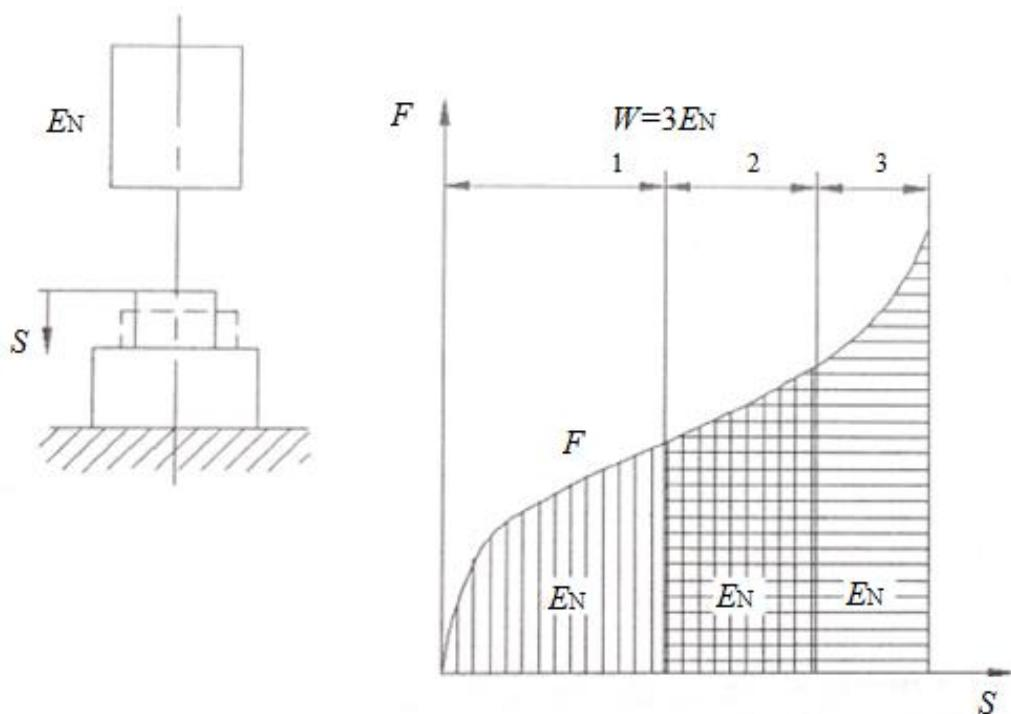
**Slika 12. Strojevi sa zagarantiranom energijom. Gravitacijski bat (shematski); podjela postupka deformiranja na tri radna hoda (udarca) [3]**
