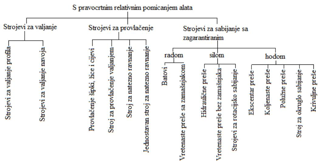
Slika 9. Shema podjele strojeva s pravocrtnim pomicanjem alata
