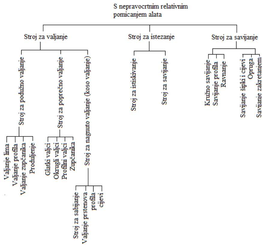
Slika 10. Shema podjele strojeva s nepravocrtnim pomicanjem alata
