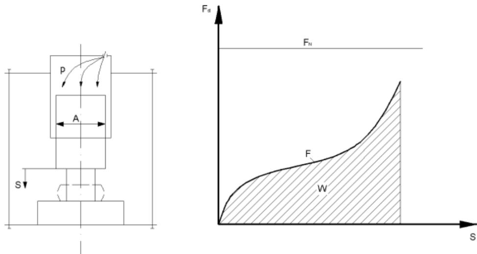
**Slika 13. Strojevi sa zagarantiranim silom (Hidraulična preša – shematski i ograničenje sile)**
